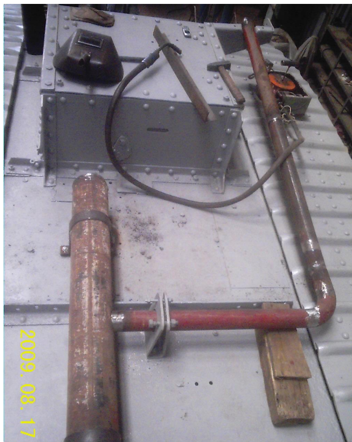
Фото 41. Сборка выхлопной трубы на танке
