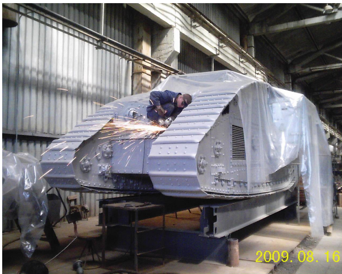
Фото 44. Окончательная зачистка заусениц и грунтовка под покраску
