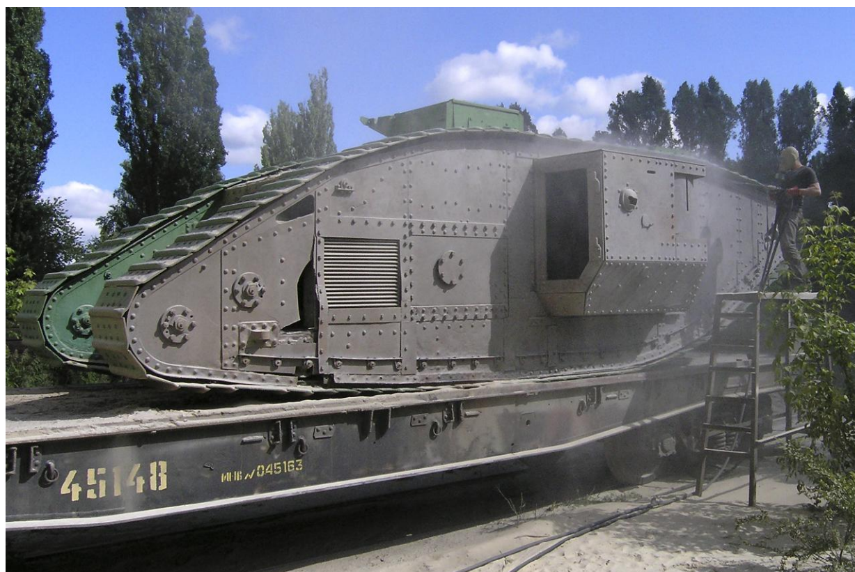
Фото 22. Продолжение пескоструйной обработки поверхности танка
