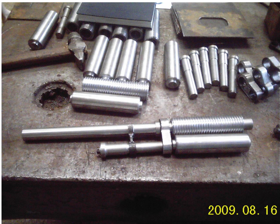
Фото 32. Заготовки на муляж пулемета и готовый к сварке пулемет
