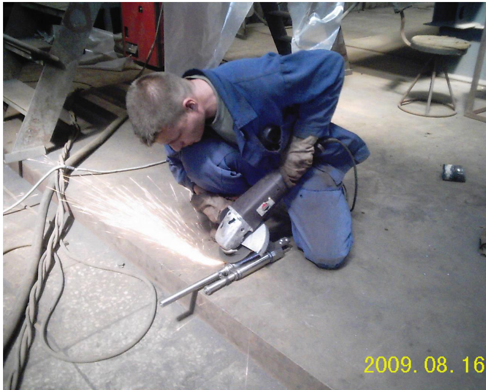
Фото 35. Последний штрих – облой убирают с муляжа пулемета Установка пулемета на танк. Фото 36.
