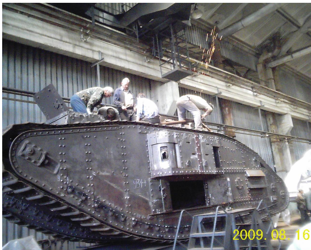
Фото 42. Монтаж выхлопной трубы на танке
