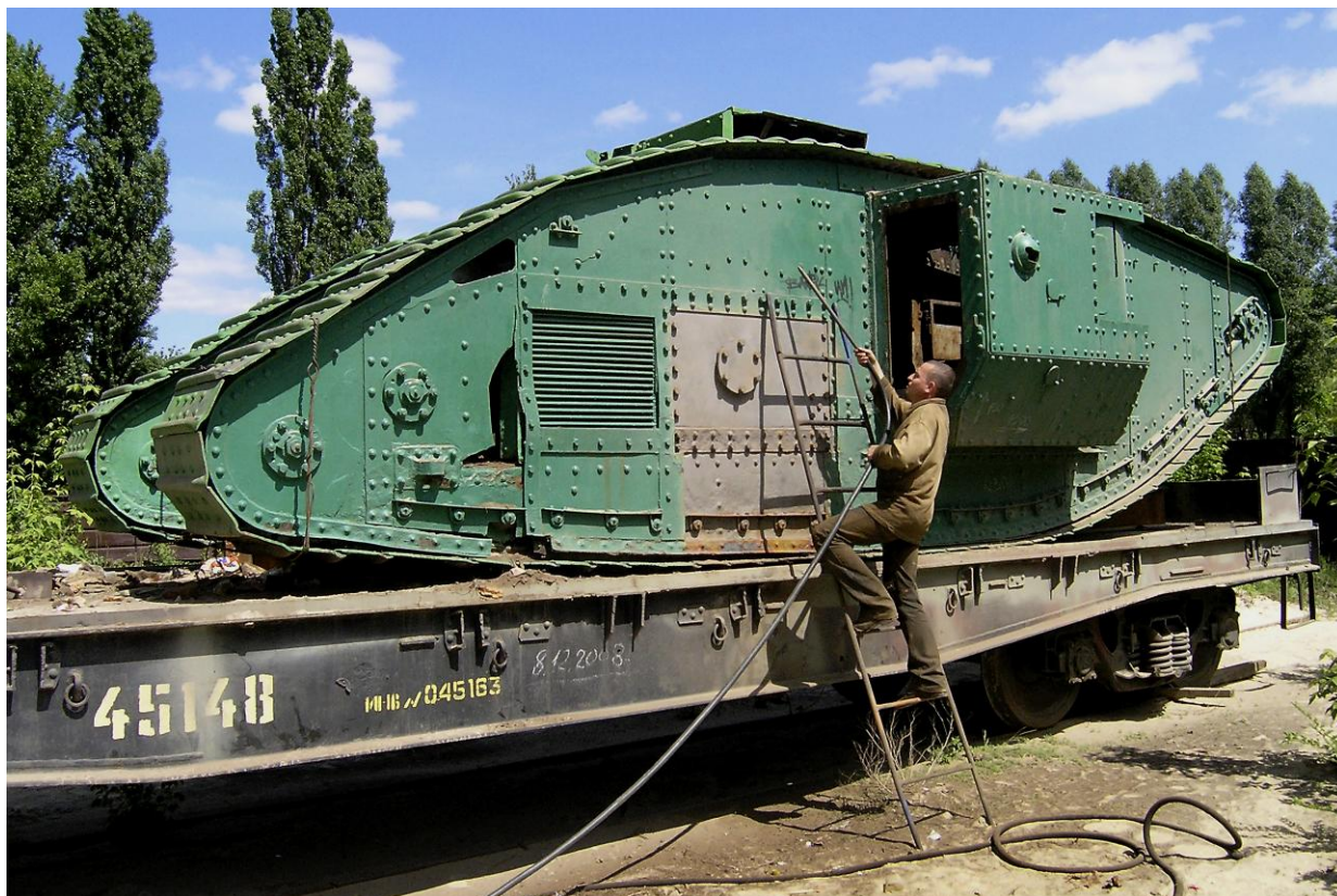
Фото 21. Начало пескоструйной обработки поверхности танка
