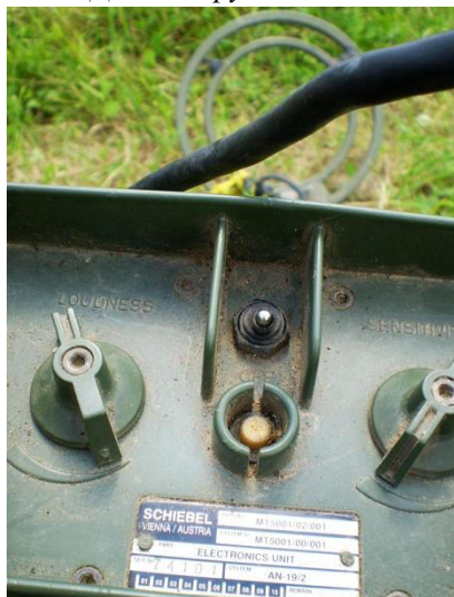
ФОТО 7. Панель управления миноискателя Schiebel AN-19/2. Фото Дениса Трушина
