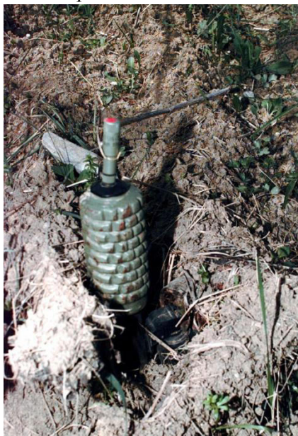
ФОТО 20. Противопехотная осколочная заградительная мина ПМР-2 производства СФРЮ
