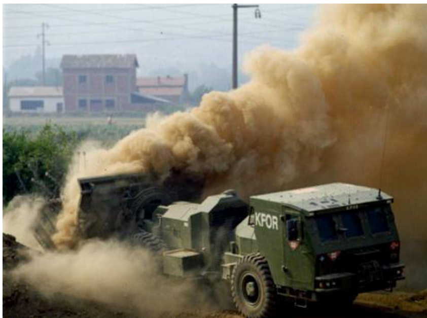
ФОТО 49. Датская машина разминирования Хидрема в работе в Косово
