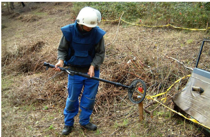
ФОТО 41. Проверка автором чувствительности миноискателя МД-8 британского производства. Фото автора
