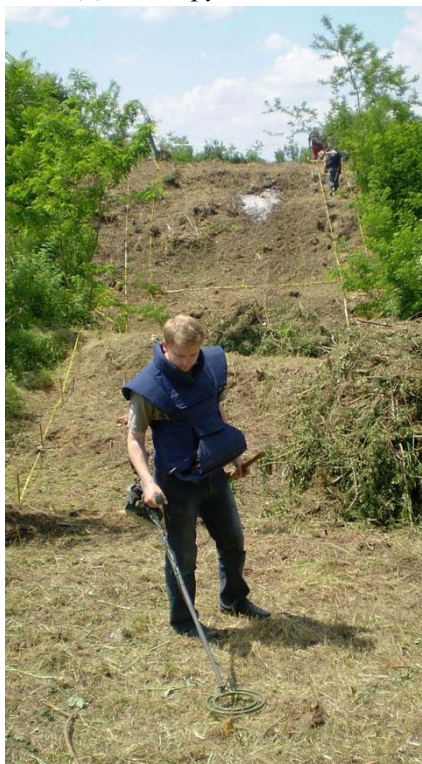
ФОТО 42. Работа с миноискателем Шибел (Schiebel AN-19/2). Фото Дениса Трушина
