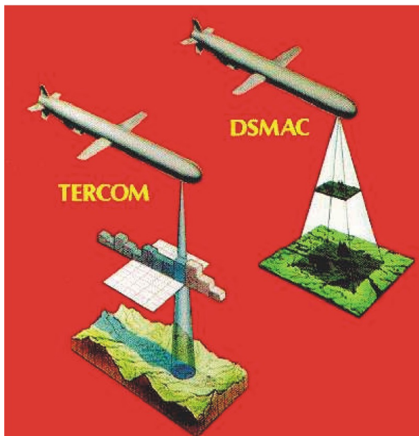
ФОТО 47. Принципы действия TERCOM и DSMAC
