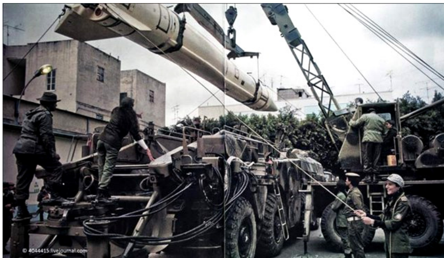
ФОТО 51. Тренировка по заряданию СПУ 9П117М комплекса 9К72 Scud-B вооруженных сил Ливии, фото не позже 1981 г.: militaryrussia.ru/blog
