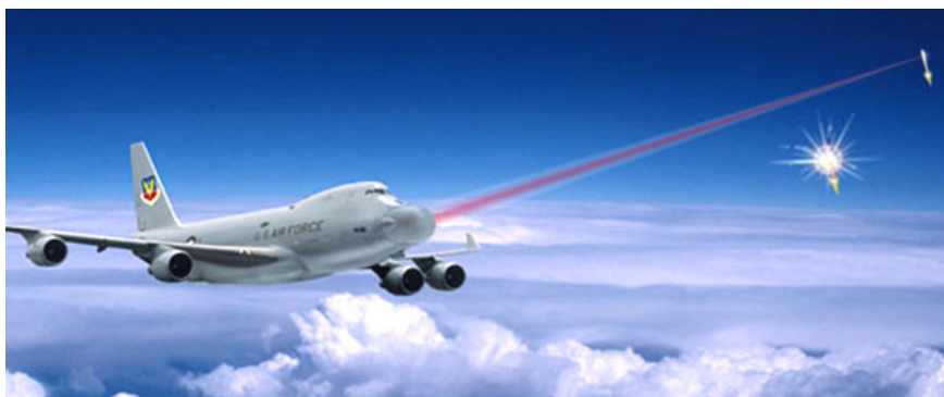
ФОТО 22. Принцип работы установки YAL-1A
