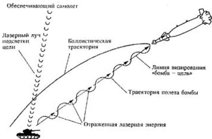
ФОТО 9. Принцип действия лазерных управляемых авиабомб: Журнал Министерства Обороны Российской Федерации «Зарубежное военное обозрение»
