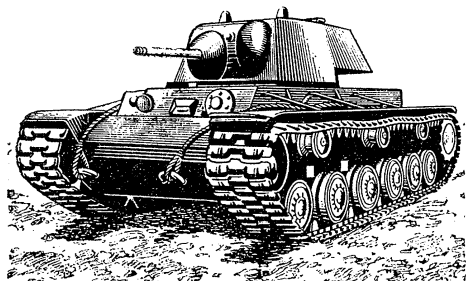
Рис. 14. Танк с противоснарядным бронированием КВ-1
