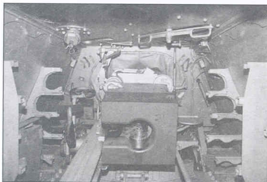
Общий вид боевой рубки. Хорошо видна казенная часть 128-мм орудия PaK 80. Справа и слева на стенах – держатели оружейных гильз, слева над орудием на крыше САУ – казенная часть противопехотного гранатомета, служившего для обороны машины от пехотных подразделений в ближнем бою. Место командира орудия (наводчика) – слева.
