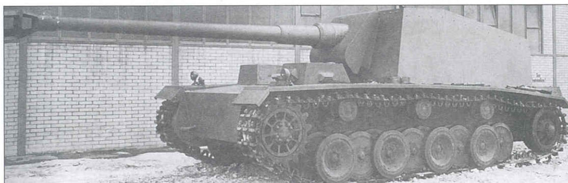
Самоходный истребитель танков Pz.Sfl. V со 128-мм пушкой Kanon 40 L/61 во дворе фирмы Alkett. 1942 г. Отчетливо видны особенности удлиненного шасси экспериментальной машины VK 3001 (H).
