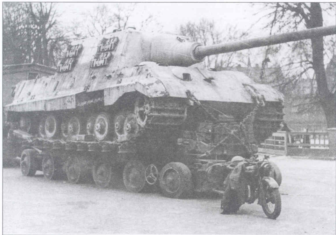
«Ягдтигр» № 331 (шасси № 305004) с подвеской по типу «Порше», захваченный английскими войсками. В настоящее время экспонируется в Королевском танковом музее в Бовингтоне.
