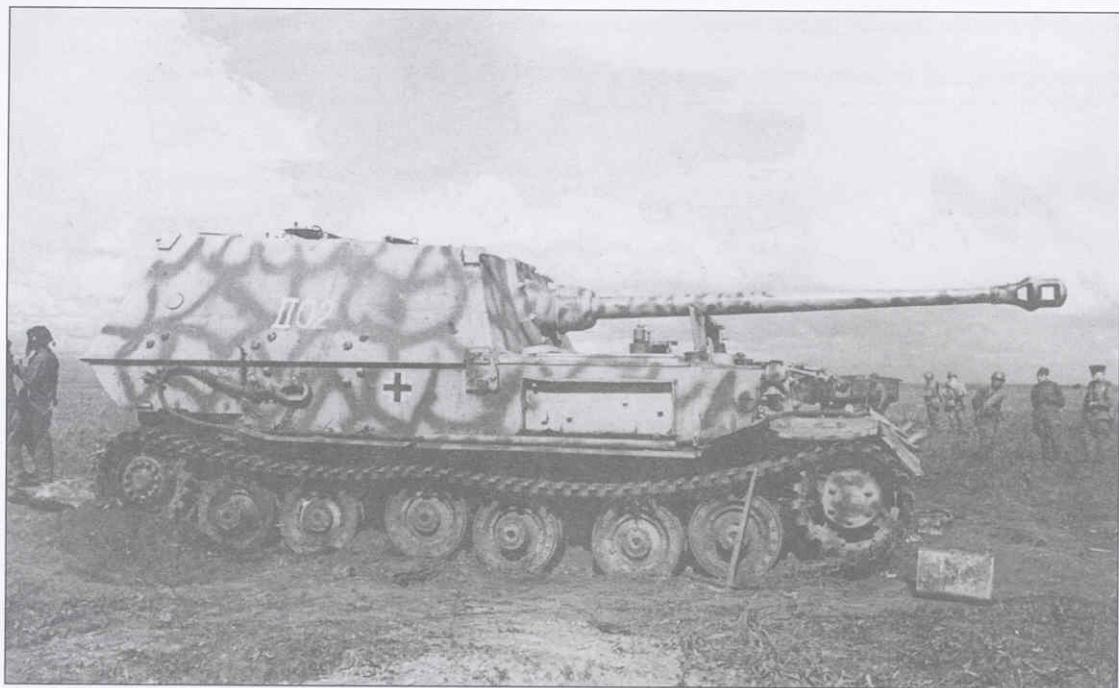
Штурмовое орудие (истребитель танков) «Фердинанд», брошенное немцами при отступлении. Северный фас Курской Дуги, август 1943 г. На фотографии изображена штабная машина 654 тяжелого истребительно-противотанкового батальона. Штурмовое орудие не имеет дополнительного щитка на орудии, присутствовавшего на большинстве боевых машин.
