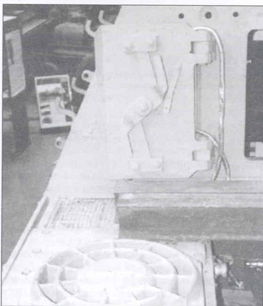
Левая распашная бронедверь. Хорошо виден механизм закрывания двери.
