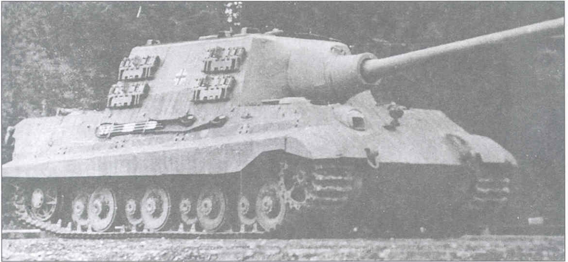
«Ягдтигр» с подвеской КБ «Порше АГ» (шасси № 305003) перед отправкой на фронт.
