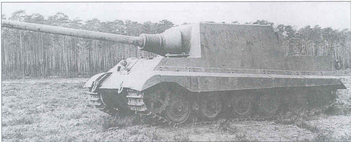
Испытания опытного образца тяжелого самоходного истребителя танков «Ягдтигр» (шасси 305002) на Кумерсдорфском полигоне 5 мая 1944 г. Наиболее характерная особенность машины — отсутствие каких-либо поручней, крюков и кронштейнов на бортовых и лобовом листах бронекорпуса. Ходовая часть полностью заимствована от тяжелого танка «Тигр II».
