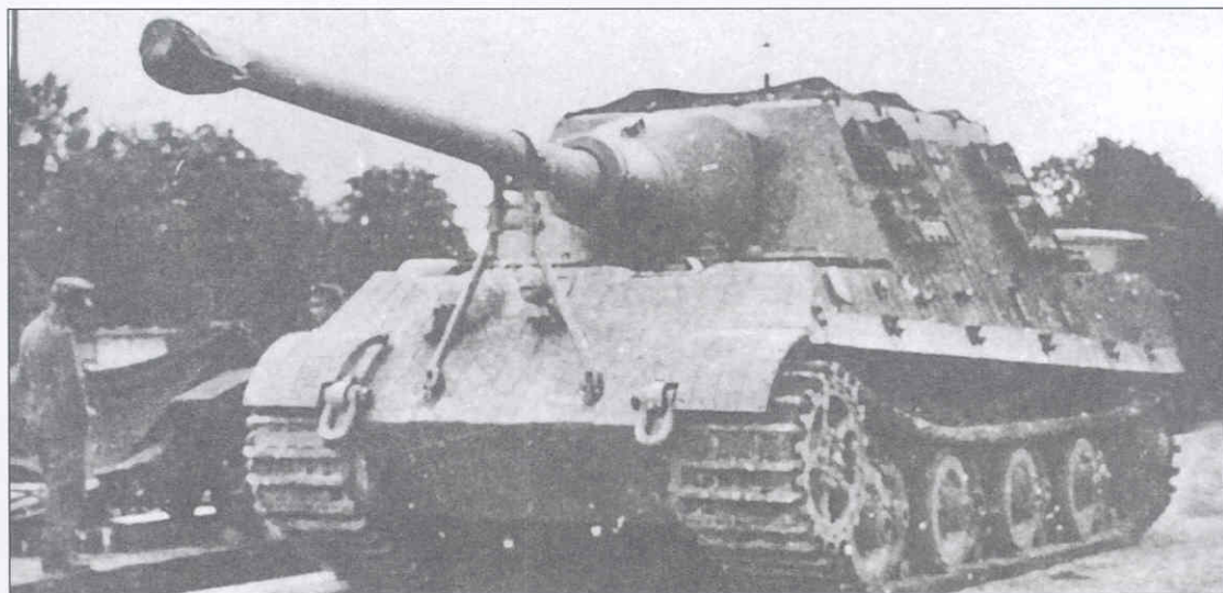
«Ягдтигр» с подвеской КБ «Порше АГ» (шасси № 305009) с транспортными гусеницами и без фальшбортов, подготовленный к транспортировке железной дорогой. Машина покрыта «циммеритом» и окрашена в грязно-желтый цвет. Внизу, та же машина после схода с ж.д. платформы. Слева от машины видны солдаты, сгружающие фальшборта. Идет подготовка к «переобуванию» машины. Сентябрь 1944 г.
