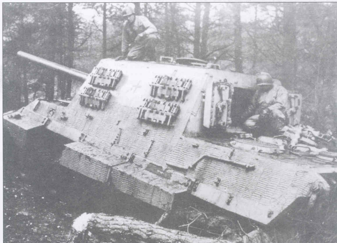
«Ягдтигр» с подвеской по типу «Порше», из 512 тяжелого истребительно-противотанкового батальона. Брошен экипажем при отступлении.
