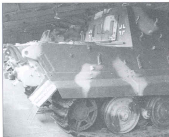
Фрагмент ходовой части «Ягдтигра», конструкции фирмы «Хеншель». Музей БТВИТ, пос. Кубинка.
