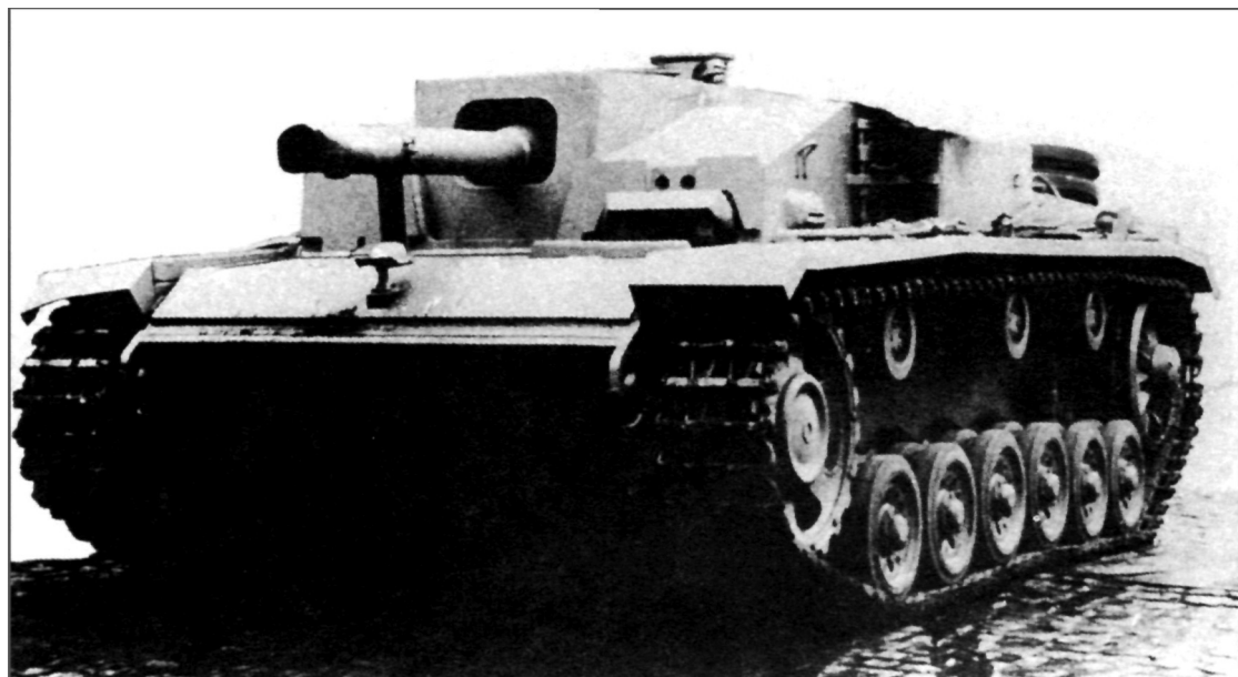
Огнеметный вариант штурмового орудия, изготовленный на базе StuG 40 Ausf F.
