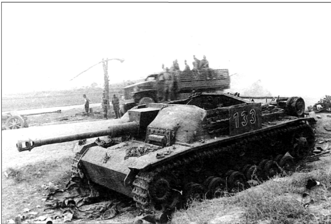
Подбитое в Румынии штурмовое орудие с толстым слоем цементной обмазки. 1944 г.
