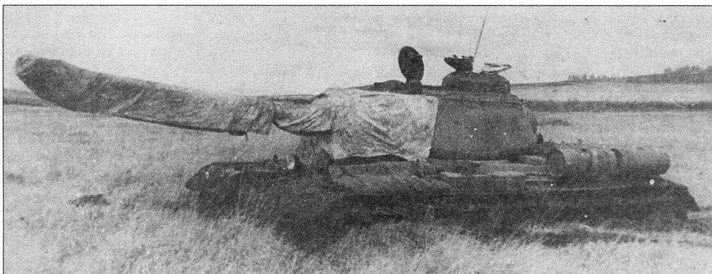
**Опытный танк ИС-122 (Объект 240), вооруженный 122-мм орудием Д-25 (А-19 танковая) во время Государственных испытаний. Осень 1943 г.**
