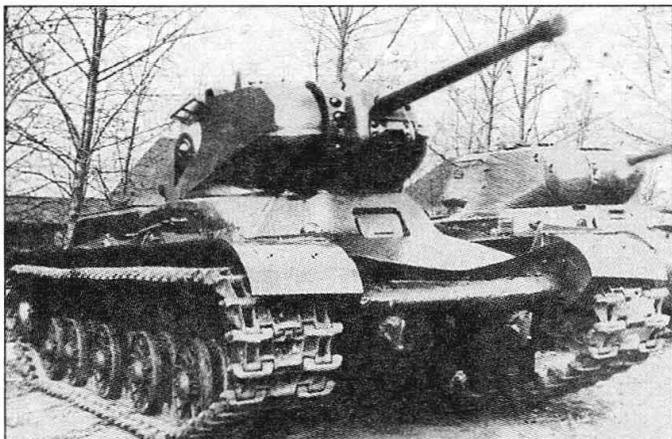
Тяжелый по бронированию танк с высокой скоростью движения – KV-13.
