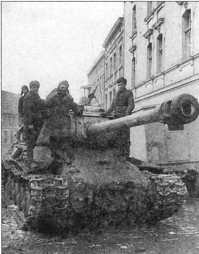
**В ходе уличных боев танкисты часто устанавливали кормовой пулемет на башне для обороны от немецких гренадеров. 1944 г.**
