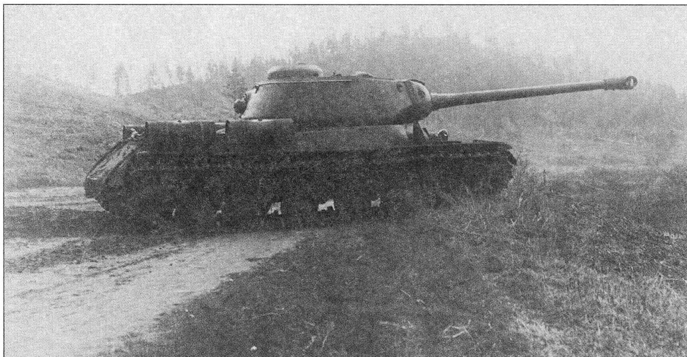
**Опытный танк ИС-122 (Объект 240), вооруженный 122-мм орудием Д-25 (А-19 танковая) во дворе Челябинского Кировского завода. Осень 1943 г.**
