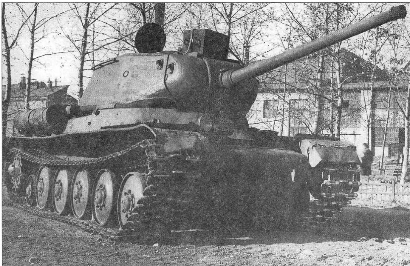
**Испытания подвески танка ИС-6 на догруженном танке ИС-85 (Объект 244).**
