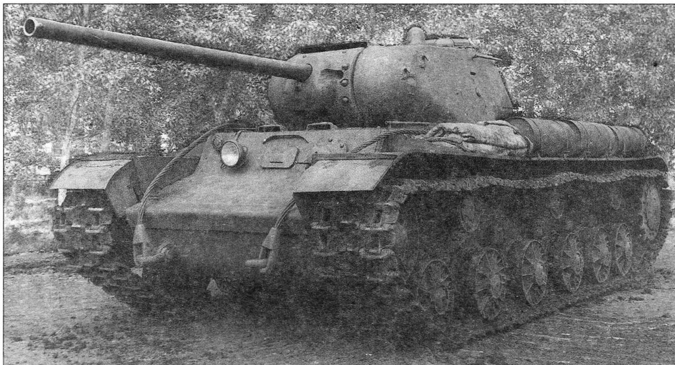
**Опытный танк КВ-1С, вооруженный 85-мм орудием С-31. Сегодня находится в коллекции музея БТВТ в Кубинке.**
