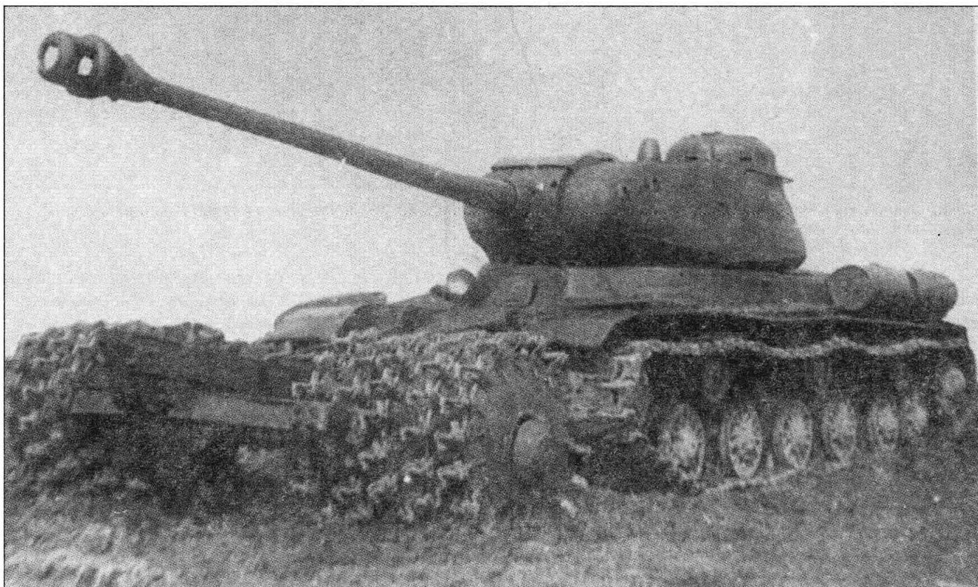
Танк ИС-122 с дульным тормозом «немецкого типа», оснащенный колеевым тралом ПТ-3, на испытаниях. 1944 г.
