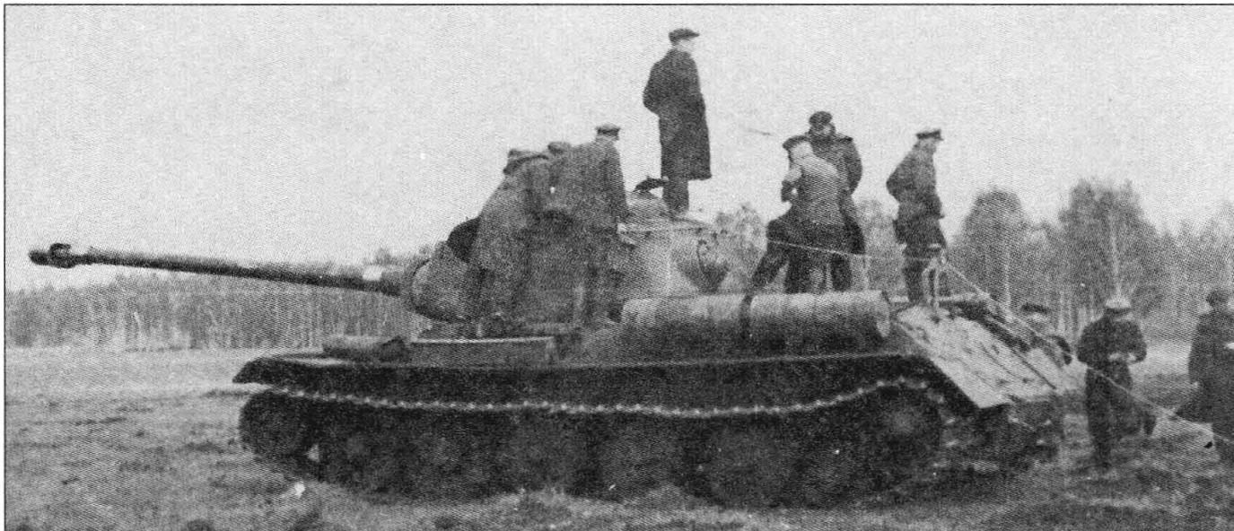
**Испытания опытного образца орудия Д-30 и вариантов подвески, предназначенных для танка ИС-6. Осень 1944 г.**
