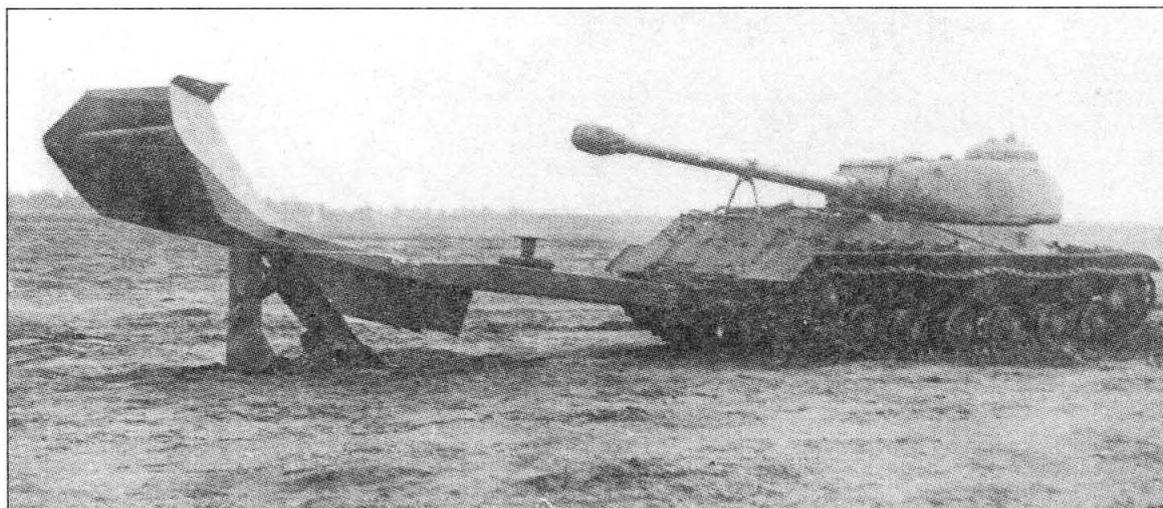
Испытания инженерного приспособления для быстрого отрывания противотанкового рва. 1945-46 гг.
