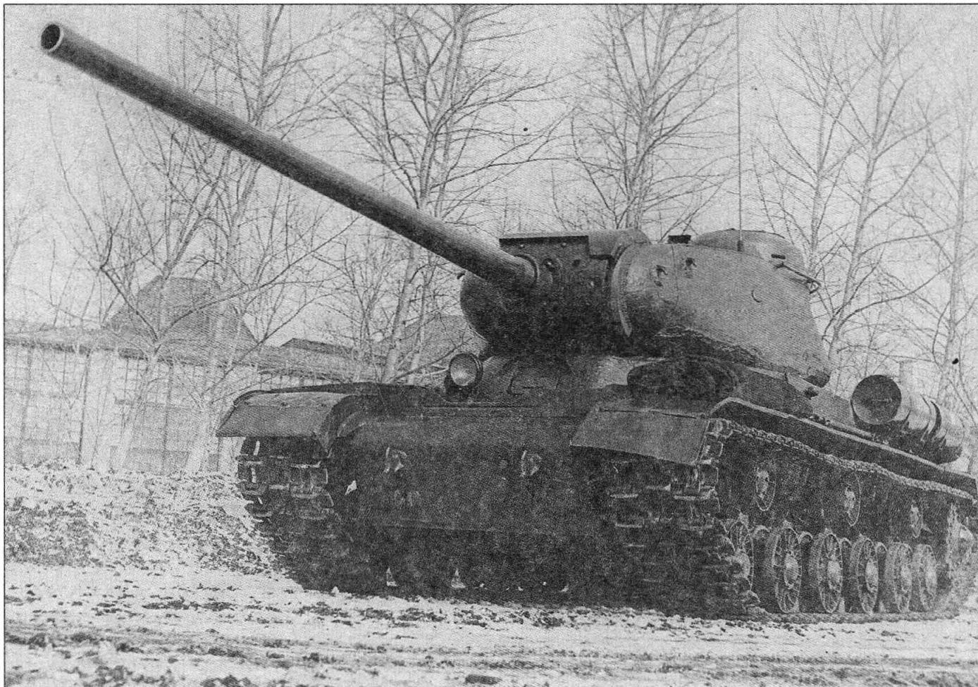
**Танк ИС-4 (Объект 245), вооруженный орудием Д-10Т, после испытаний стрельбой. Лето 1944 г.**
