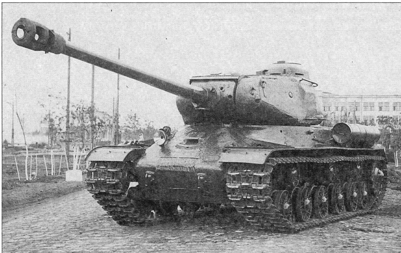
Эталонный образец танка ИС-122 «со спрямленным носом». ЧКЗ, 1944 г.
