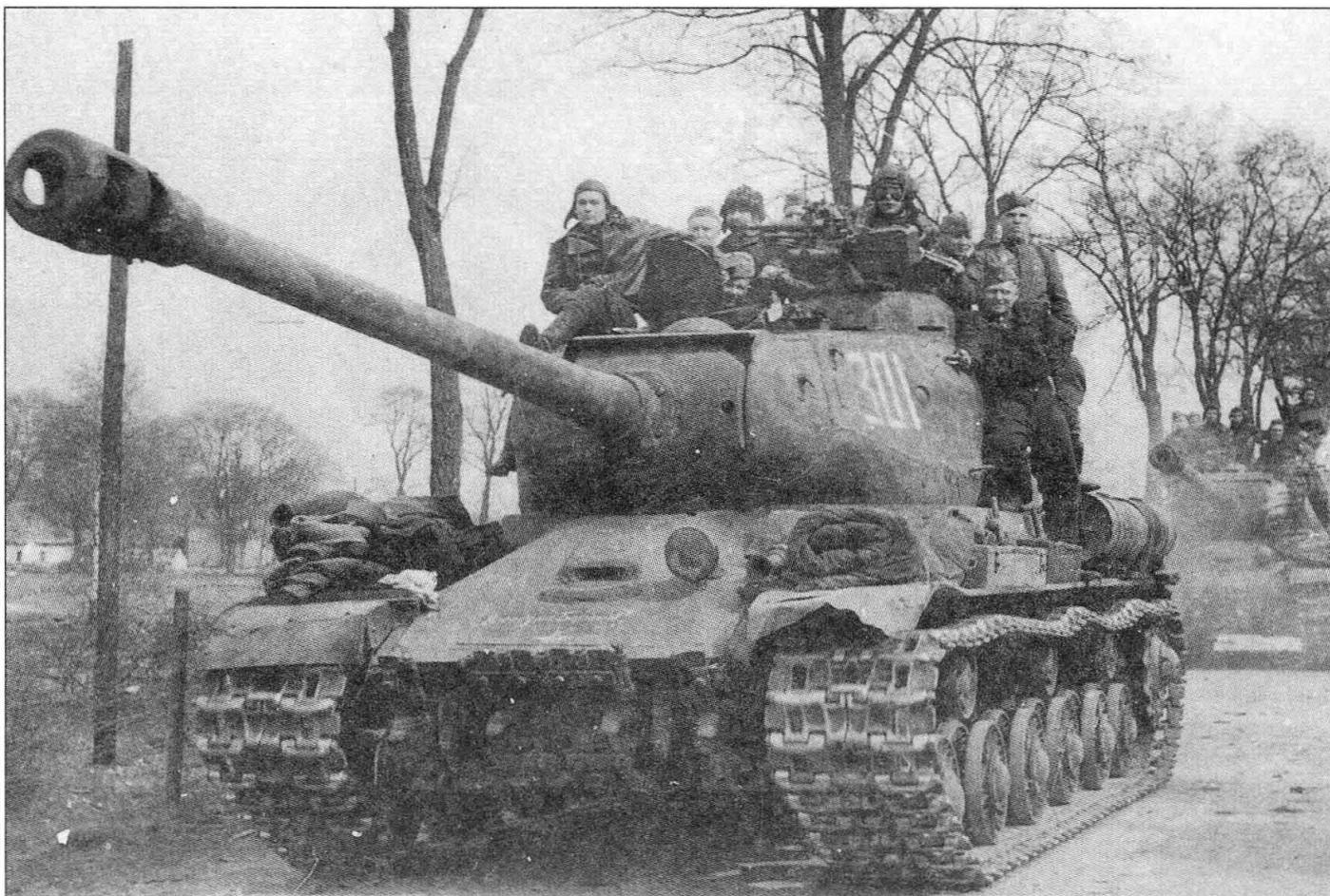
Танки ИС на Берлинском шоссе. Весна 1945 г. Изображен типичный представитель танка ИС-2 «со спрямленным носом» и сварным корпусом. Командира танка – в черных очках.
