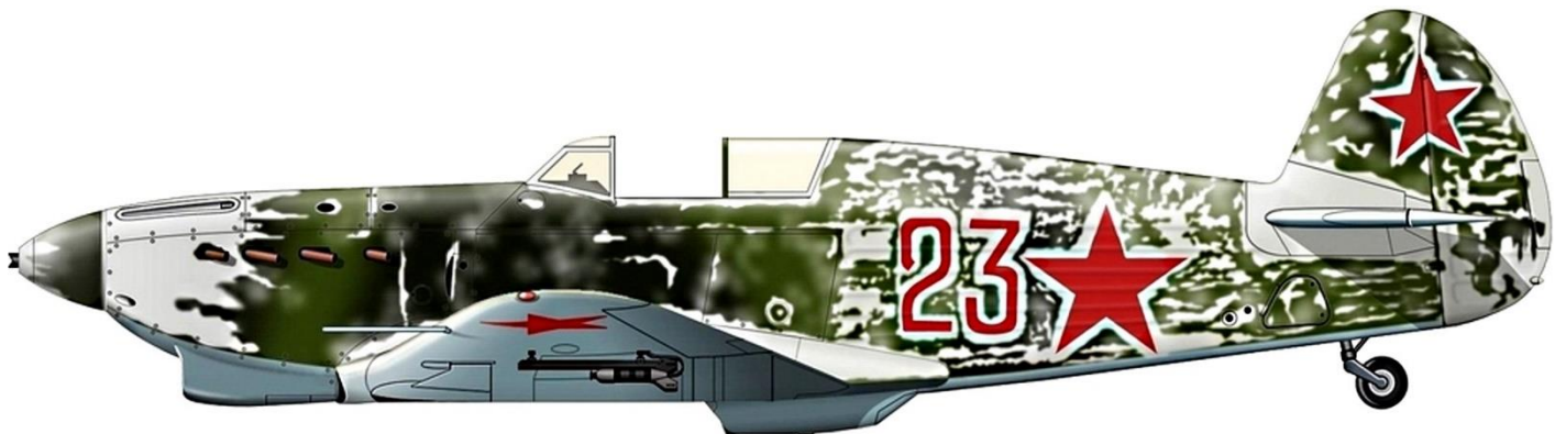
Общий вид самолёта Як-1 с установленными под крылом реактивными орудиями РО
