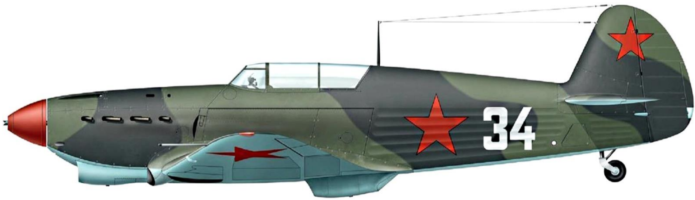
Общий вид самолёта Як-1 выпуска 1941 года оснащённого радиосвязным оборудованием
