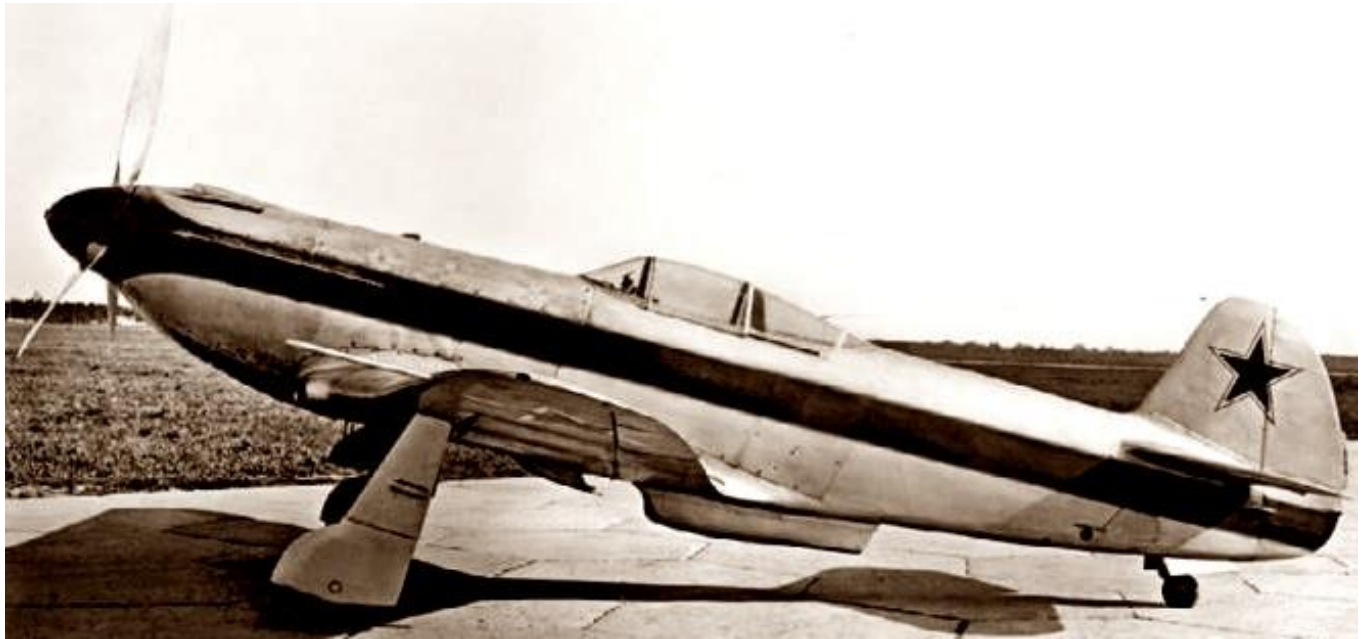
Общий вид самолёта Як-3 ВК-107А цельнометаллической конструкции
