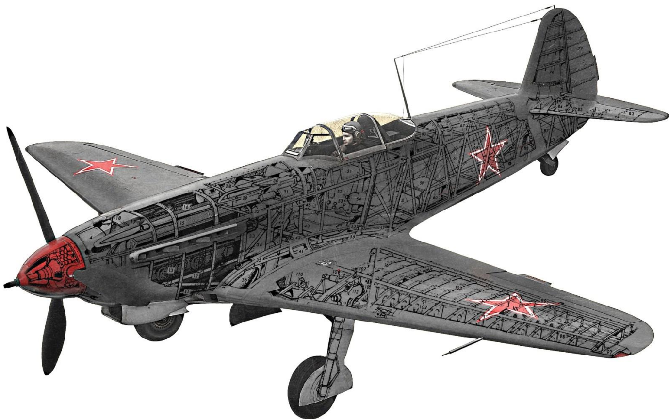
Компоновка самолёта Як-9Т
