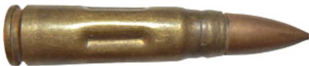
Учебный патрон со стальной латунированной гильзой. (Завод №270, 1950 г.)
