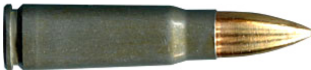
«FMJ», стальная гильза с фосфатно-полимерным покрытием, том- паковая оболочка пули
