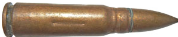
Учебный патрон с биметаллической гильзой (ГЖ). (Завод №539, 1969 г.)
