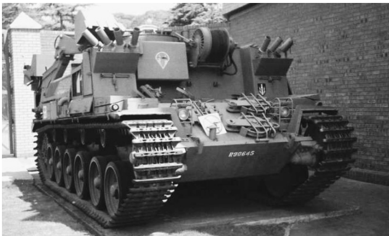
Ремонтно-эвакуационный тягач на шасси танка Элефант . (Фото Я. Либенберг.)
