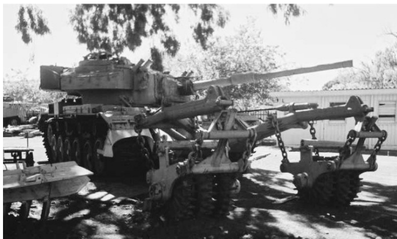
Танк Элефант с противотанковым тралом. (Фото Я. Либенберг.)
