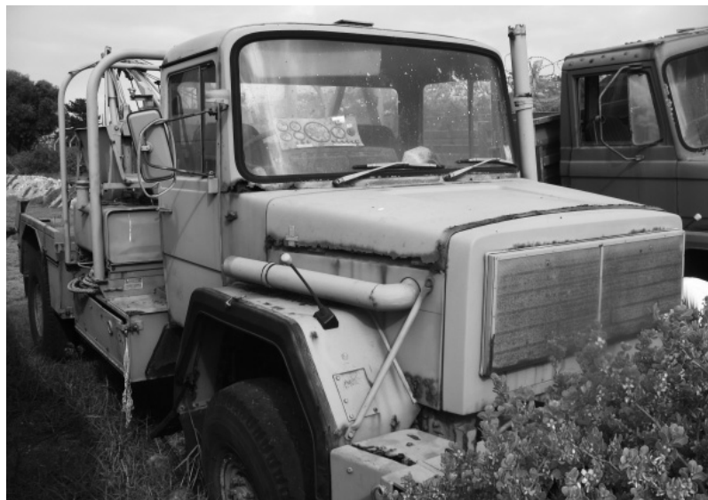
Ремонтно-эвакуационная машина на шасси Самил-50 . (Фото Г. Шубина.)
