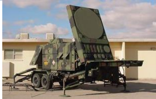
Рисунок 11: Многофункциональная РЛС с ФАР AN / MPQ-53 «Патриот».
