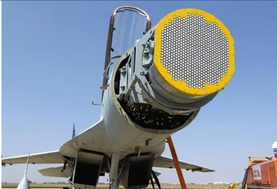
Рисунок 25: РЛС управления огнем с фазированной антенной решеткой на истребителе МиГ-35
