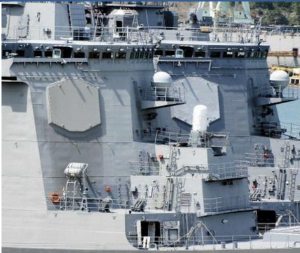
Рисунок 29: РЛС с фазированной антенной решеткой, используемая в системе ПВО и противоракетной обороны США Aegis
