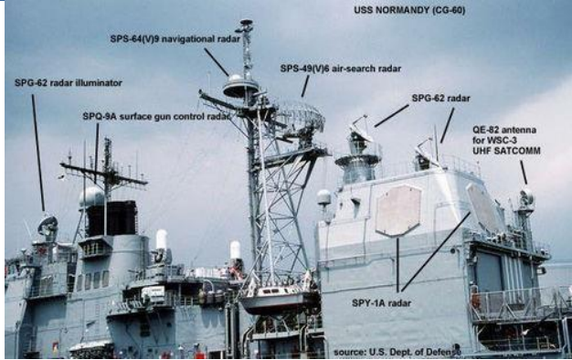
Рисунок 10: Корабельная многофункциональная РЛС с ФАР «Aegis»
