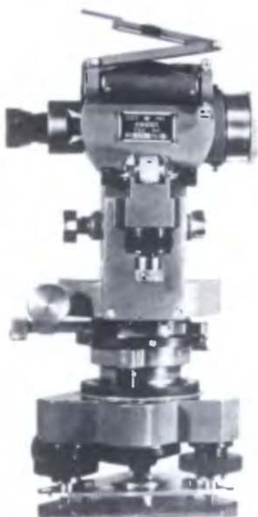
Рис. 7 Теодолит ТТ-3. Общий вид
