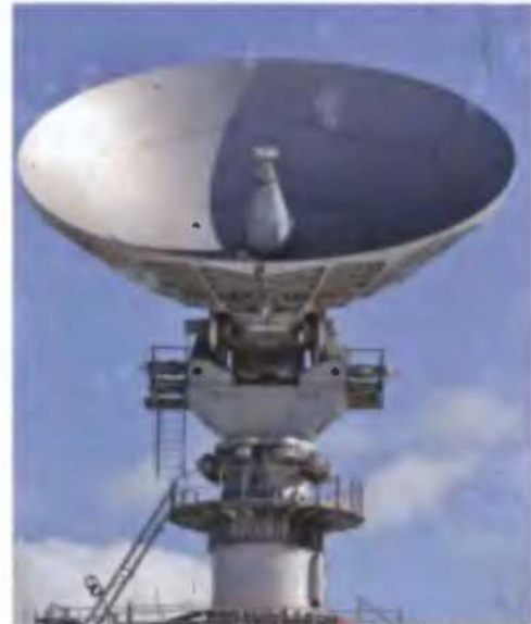
Рис. 8 «Кама-ИК» - высокоточная РЛС траекторных измерений. Предназначена для высокоточного измерения координат динамических целей
