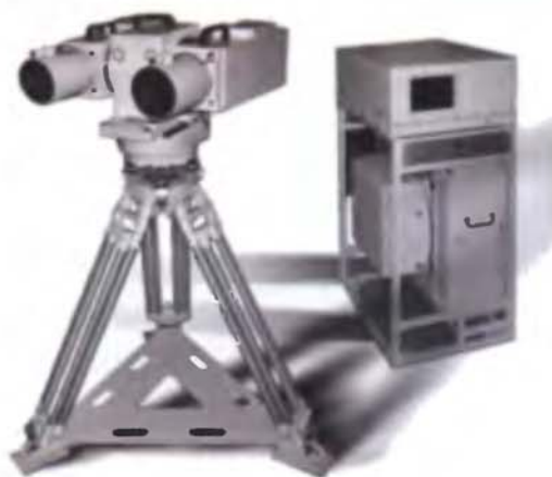
Рис. 4, рис. 5, рис. 6 Мобильный видеорегистрирующий комплекс «Кратность». Мобильный, малогабаритный, дистанционно управляемый по радиоканалу видеорегистрирующий комплекс предназначен для определения параметров траектории высокодинамичных объектов на конечных участках траектории и величины промаха
