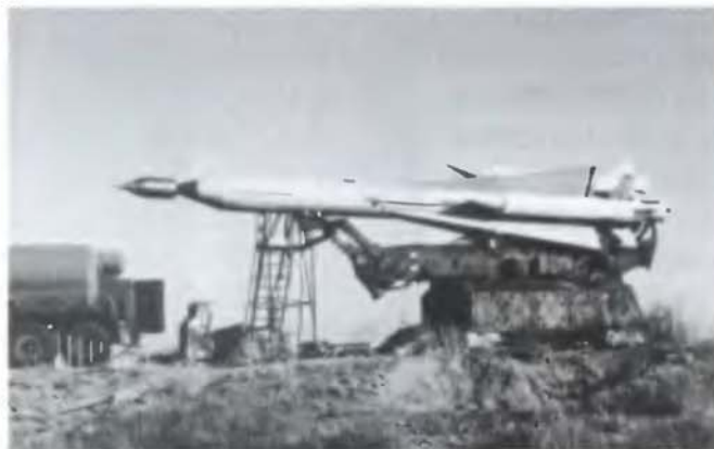
Рис. 7 Экспериментальная ракета 5В21 с ГПВРД на пусковой установке
