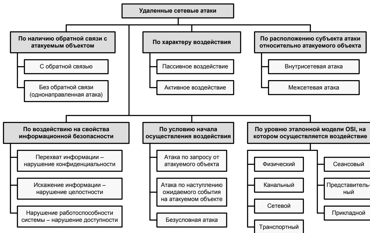
Рис. 4.4. Классификация удаленных сетевых атак
