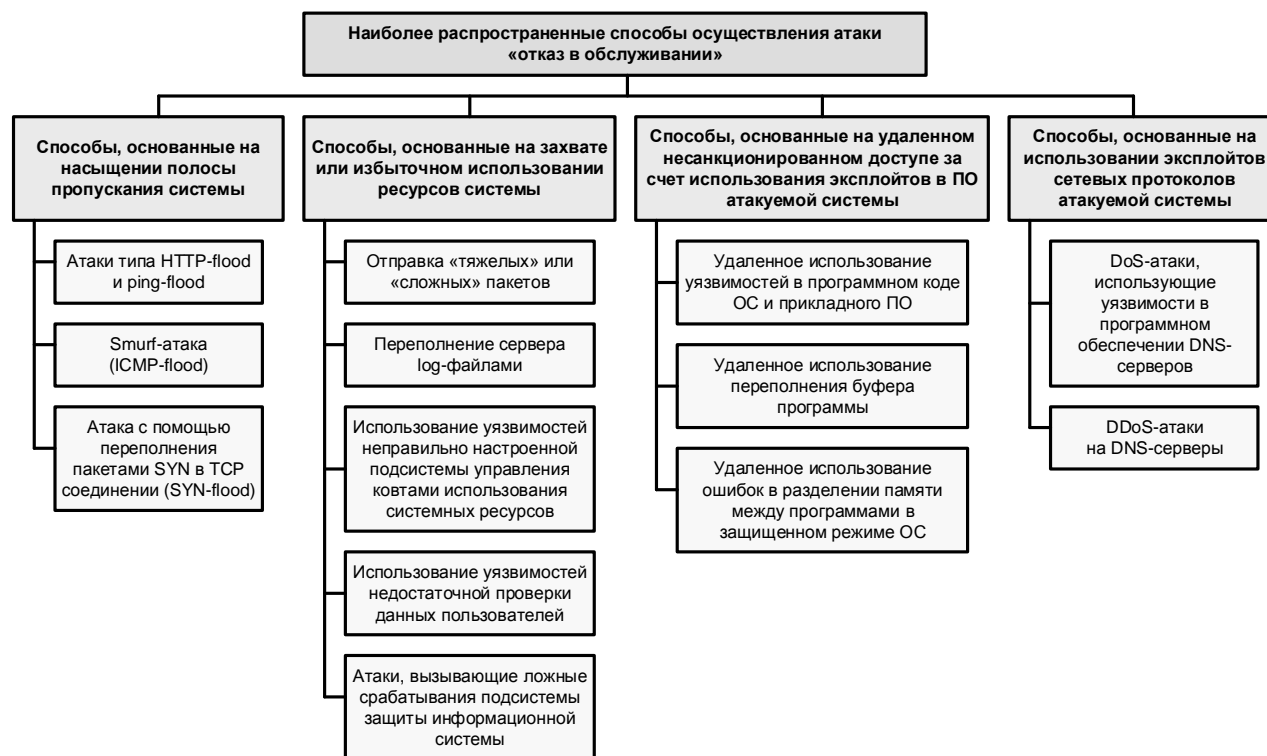
Рис. 4.6. Наиболее распространенные способы осуществления атаки «отказ в обслуживании»
