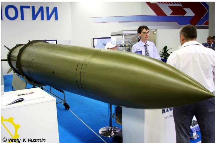
ФОТО: Твердотопливная, одноступенчатая, управляемая на всей траектории полета, с неотделяемой в полете головной частью ракета комплекса Искандер-Э (Iskander-E missile)
