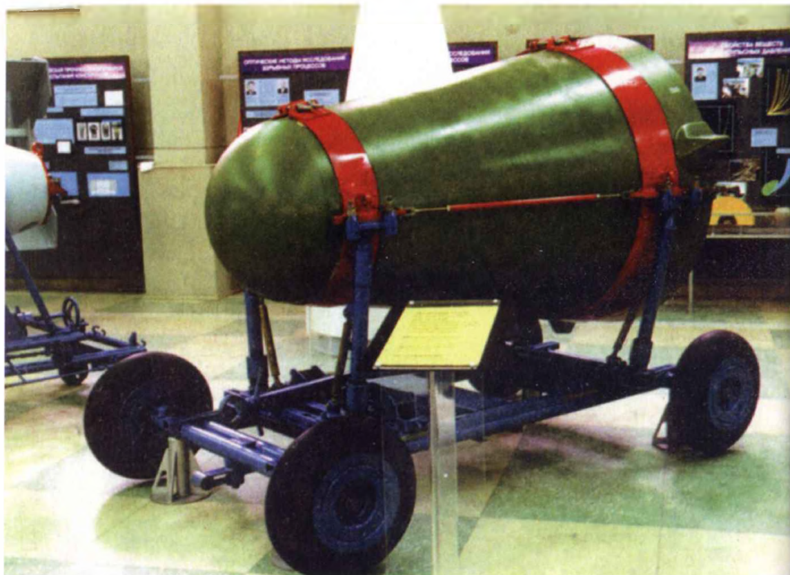
Музей ядерного оружия РФЯЦ-ВНИИЭФ. Боевой блок для РГЧ стратегической ракеты с термоядерным зарядом. На вооружении с 1970 г. Энерговыведение – более 2 Мт т. э.
