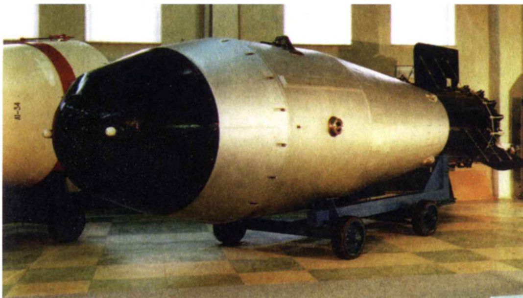
Музей ядерного оружия РФЯЦ-ВНИИЭФ. Самый мощный термоядерный заряд. Испытан 30 октября 1961 г. на неполную мощность. Энерговыделение – 50 Мт т. э.
