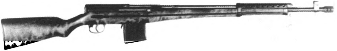
Самозарядная винтовка ТаРаКо (прицел и ствольная накладка отсутствуют)
