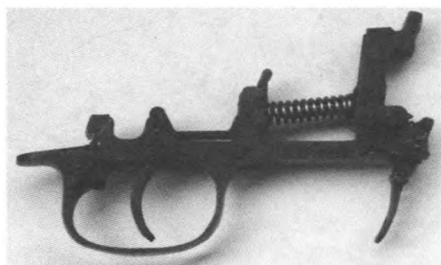
Ударно-спусковой механизм винтовки СВТ-40 (в сборе)
