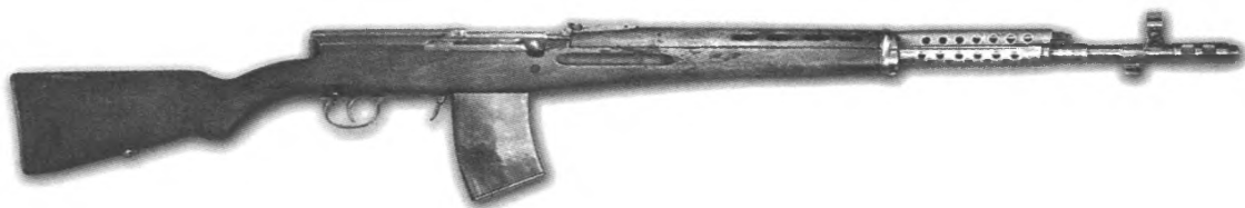
Винтовка АВТ с опытным коробчатым магазином емкостью 15 патронов
