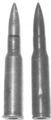
Слева: штатный 7,62-мм винтовочный патрон; справа – опытный бесфланцевый 7,62-мм винтовочный патрон
