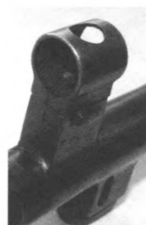
Прицельная планка к СВТ-40 без продольной канавки (с 1942 г.)
