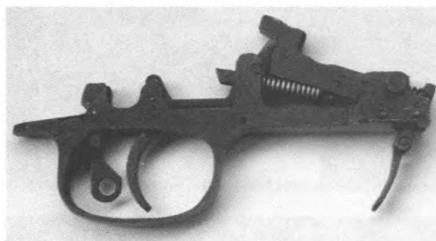
Ударно-спусковой механизм винтовки СВТ-40 (в сборе)
