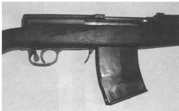
Магазин на 15 патронов конструкции Ф.В. Токарева, изготовленный из двух сваренных магазинов на 10 патронов
