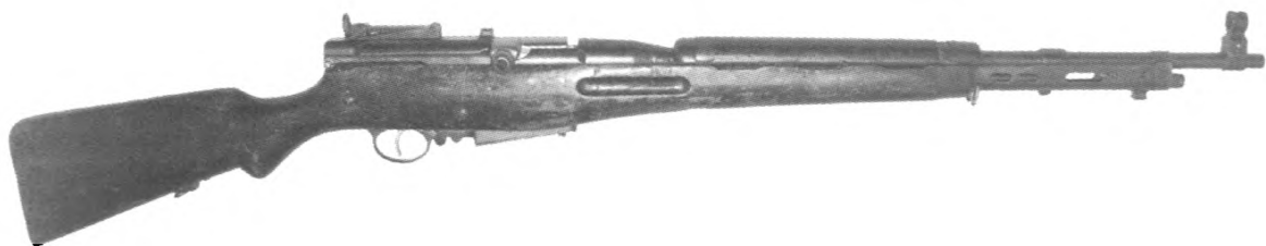
Рис. 4.16. Самозарядная винтовка Дегтярева обр. 1930 года с магазином на пять патронов
