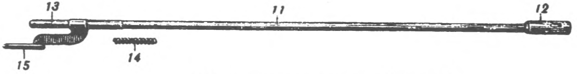
Шток с толкателем и пружиной.
