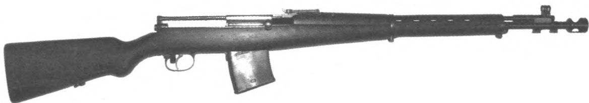
Автоматическая винтовка Токарева 1933 года (ТГМО)
