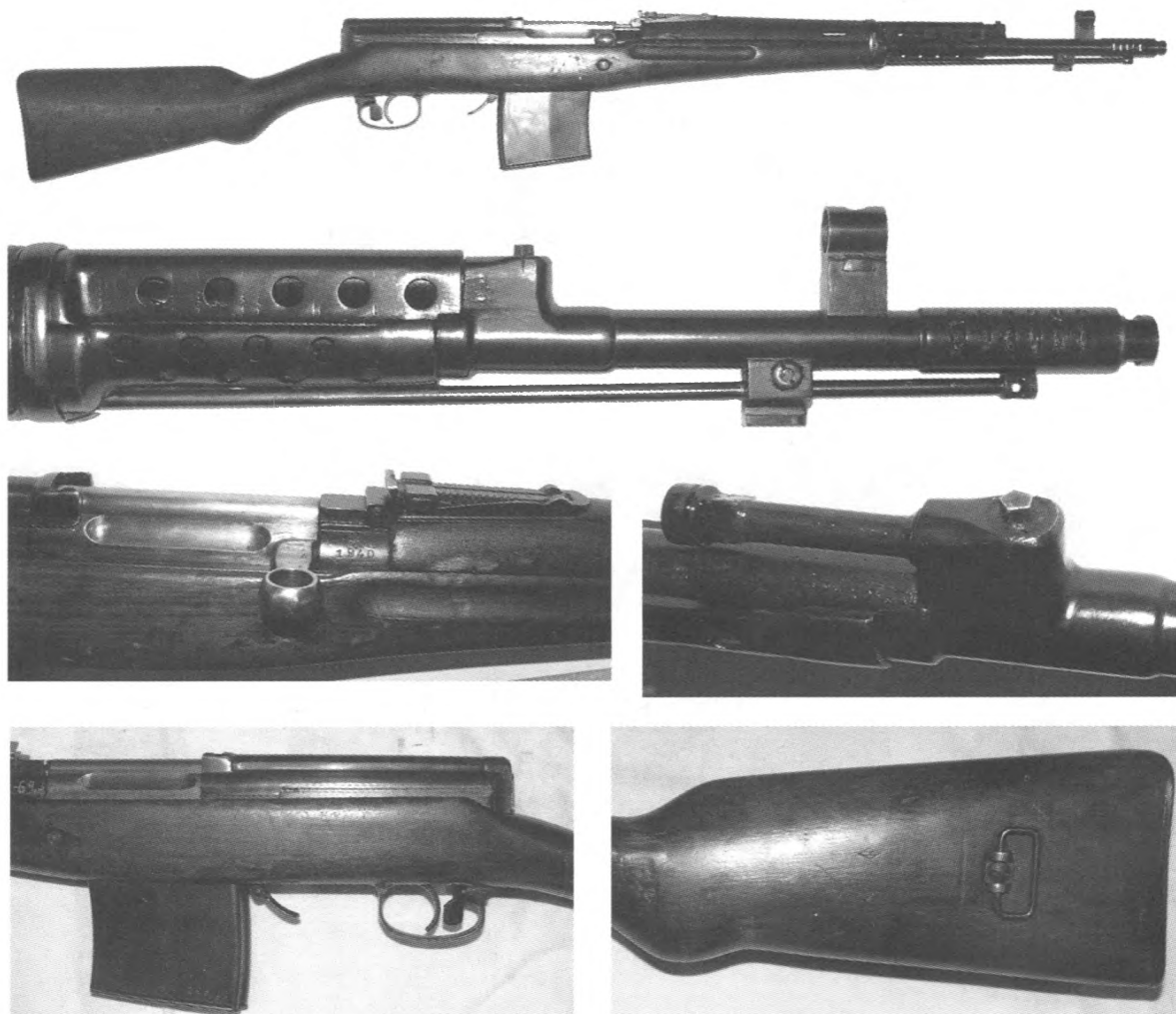
Автоматический карабин 1940 г. с вертикальным газорегулятором (ВИМАИВнВС)
