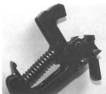
Ударно-спусковой механизм винтовки СВТ-38 (в сборе)
