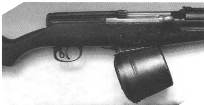
Барабанный магазин конструкции Бубнова – Скворцова для винтовки АВТ
