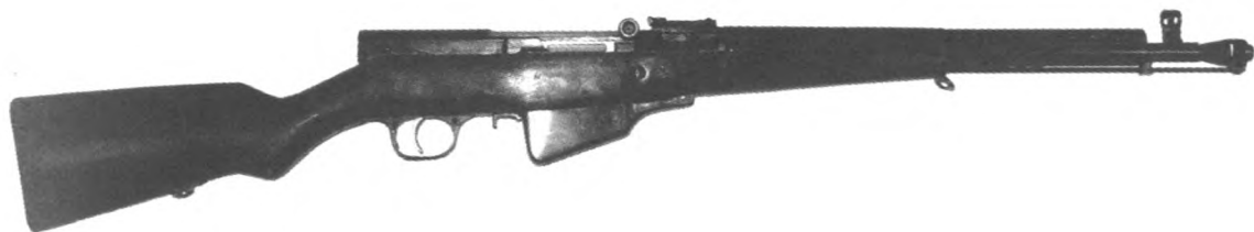
Автоматический карабин Симонова 1941 года с постоянным магазином на 10 патронов (ВИМАИВиВС)
