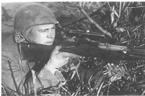
Рядовые винтовки СВТ-40, переделанные в снайперские путем установки оптических прицелов на самодельных кронштейнах
