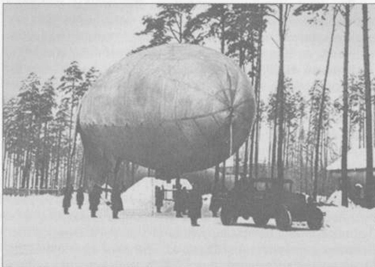
Вывод аэростата на подъем. Идет присоединение к тросу лебедки. Зима 1943 года
