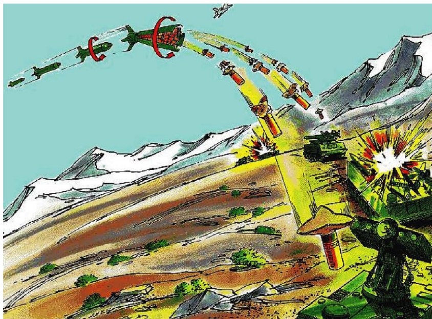
ФОТО 15. Способ применения кассетных кумулятивно-осколочно-зажигательных боеприпасов БЛУ-97Б (BLU-97B) авиацией США
