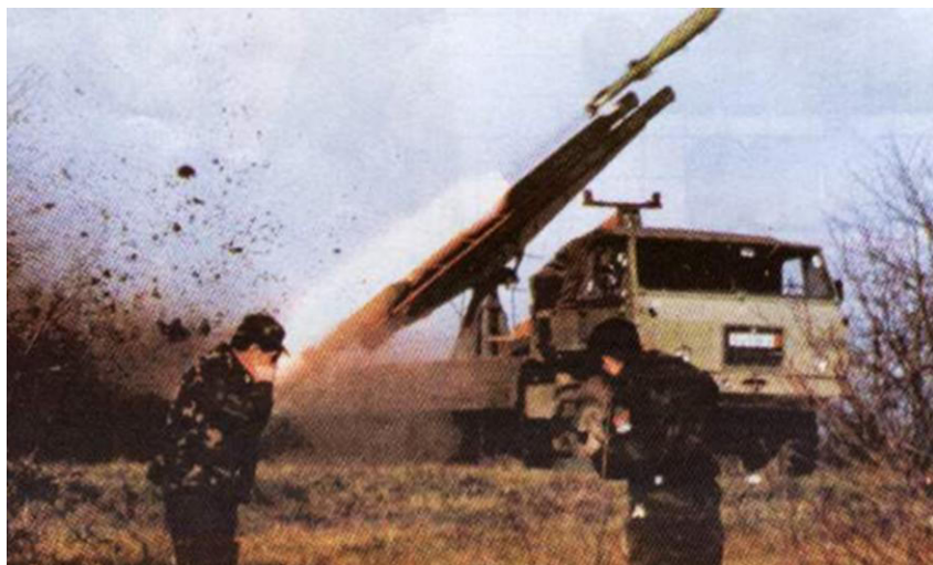
ФОТО 51. Запуск авиабомб с ракетными двигателями с сербской наземной установки 52
