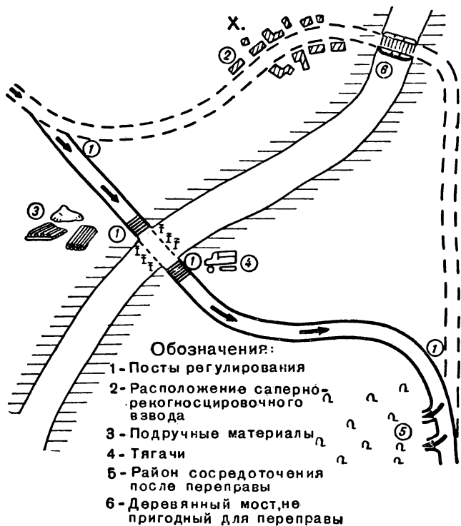
Рис. 15. Схема организации переправы танков по льду
