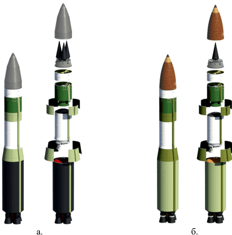
Рис. 5.2. МБР LGM-30G Minuteman-3: МБР с разделяющейся боевой частью (а); МБР с одиночной боевой частью (б)
