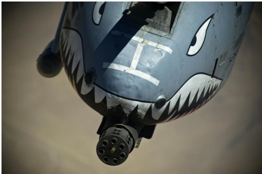
ФОТО 120. Вид на семиствольную 30-миллиметровую автоматическую пушку GAU-8А «Avenger»
