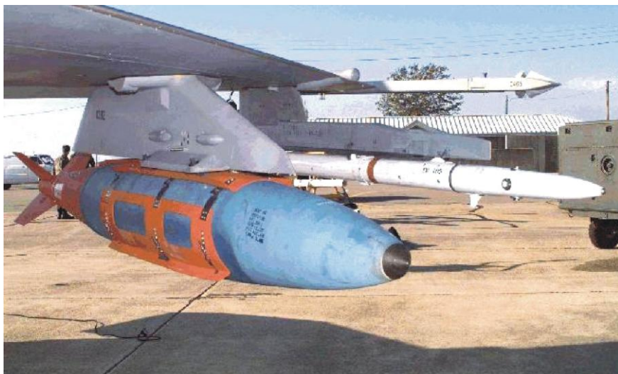
ФОТО 109. Американская авиабомба Mk 84 калибра 2000 фунтов, оснащенная комплектом JDAM
