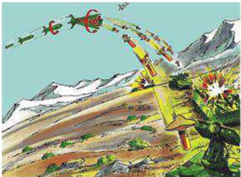
ФОТО 125. Принцип действия американских осколочно-кумулятивно-зажигательных боеприпасов BLU-97 A/B, применявшихся из кассетных контейнеров CBU-87 и CBU-89 в Югославии в 1999 году
