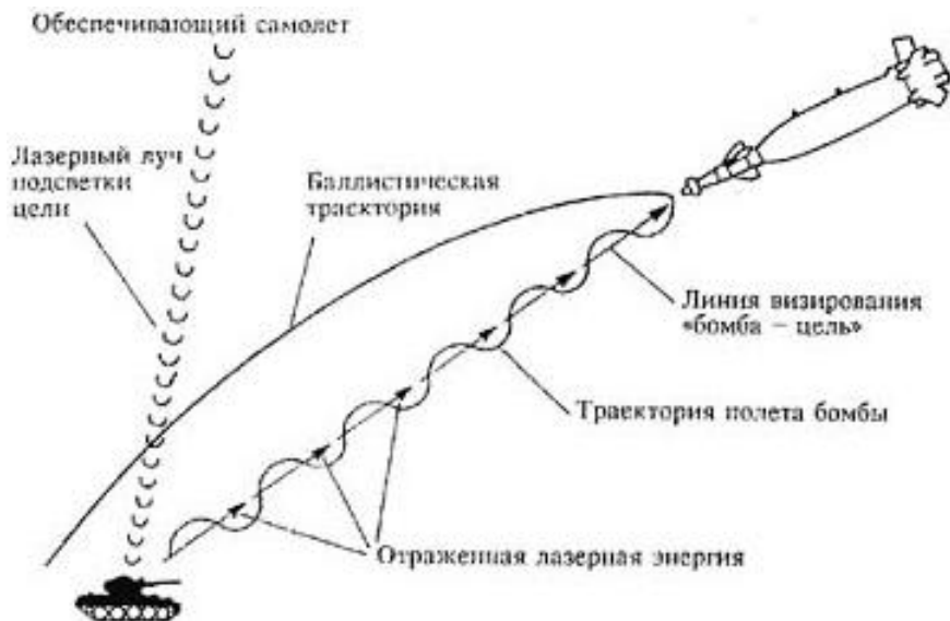
ФОТО 67. Принцип действия лазерного наведения управляемой авиабомбы
