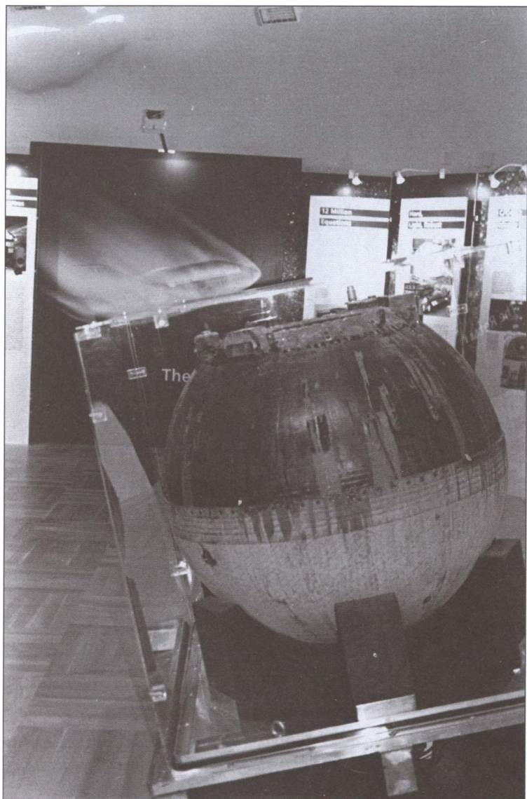
Обгоревший шар спускаемого аппарата — вот и все, что остается от ракеты и космического корабля после спуска с орбиты
