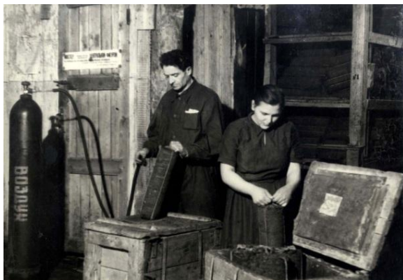
Рис. 6. Закладка патронов из торфа-сфагнома в термосы для перевозки к месту взрыва. 1944 г.
