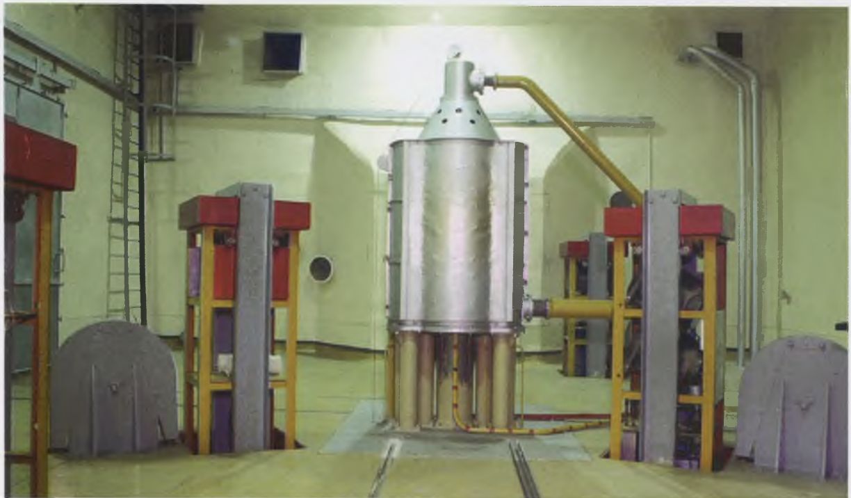
Реактор на быстрых нейтронах БИГР
