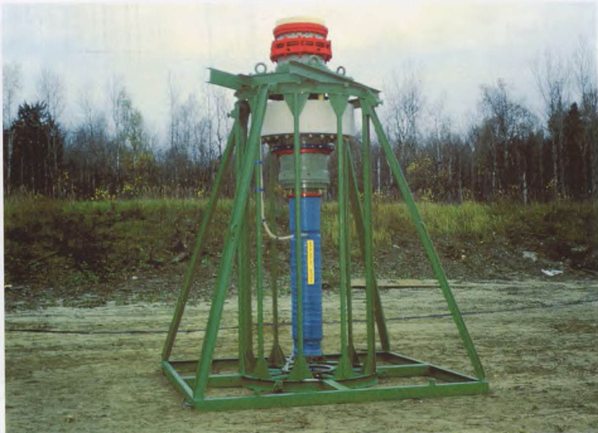
Спирально-дисковый взрывомагнитный генератор (ВМГ) «Поток»
