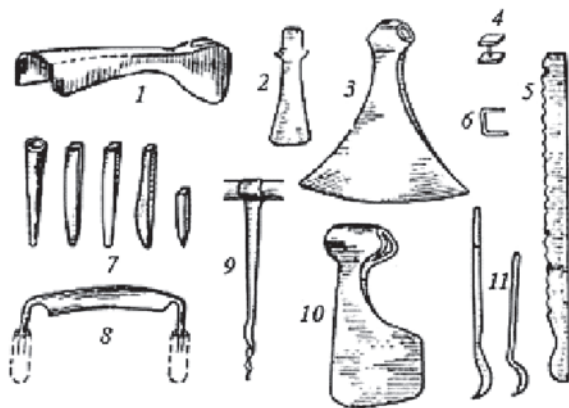
Инструменты, которыми древние славяне строили суда: 1 — тесло; 2 — железка рубанка; 3 — секира; 4 — заклёпка; 5 — пила; 6 — скоба; 7 — долото; 8 — скобель; 9 — сверло; 10 — топор; 11 — резцы.
