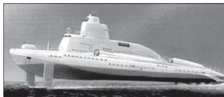
Модель катера проекта 1231 с двумя крыльями
