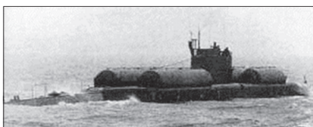
Подводная лодка проекта 613Э с электрохимическими генераторами ЦКБ «Лазурит»
