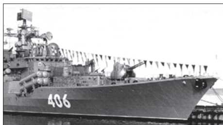
Установка АК-130 на эсминце пр. 956Э
