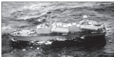
Пусковые установки ракет П-15М на ракетном катере проекта 205У, 1982 г.
