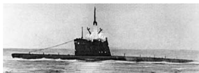
Ракета Р-11ФМ стартует с подводной лодки проекта АВ611
