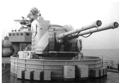
130-мм корабельный универсальный автоматизированный артиллерийский комплекс АК-130-МР-184
