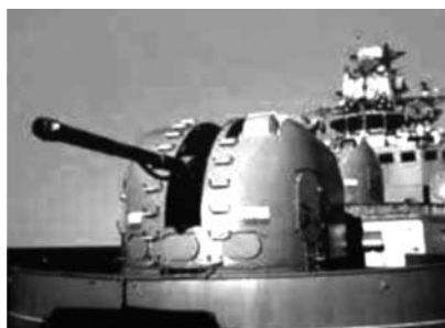
100-мм корабельный универсальный автоматизированный артиллерийский комплекс АК-100-МР-145
