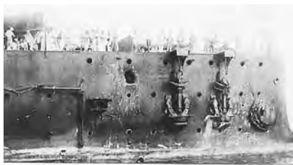
Повреждения носовой части правого борта крейсера «Аврора» в Цусимском бою
