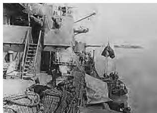
ПОГРУЗКА УГЛЯ В МОРЕ НА ЭСКАДРЕННЫЙ БРОНЕНОСЕЦ
