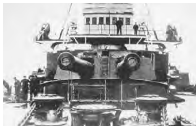
БАРБЕТНАЯ 305 ММ ДВУХОРУДИЙНАЯ УСТАНОВКА БРОНЕНОСЦА «ФУДЗИ»
