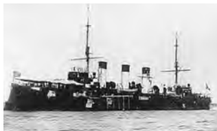
КРЕЙСЕР «ОЛЕГ» ПОСЛЕ УСТРАНЕНИЯ ПОВРЕЖДЕНИЙ (временная заделка пробоин)
