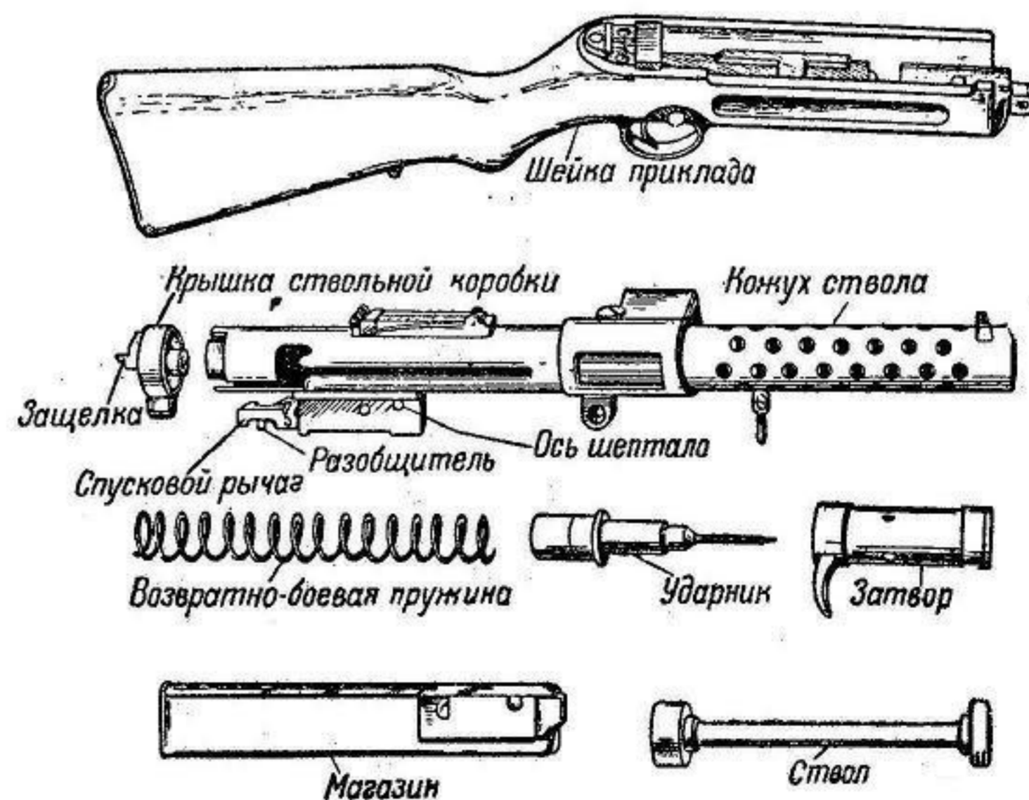
Рис. 168. Пистолет-пулемет в разобранном виде
