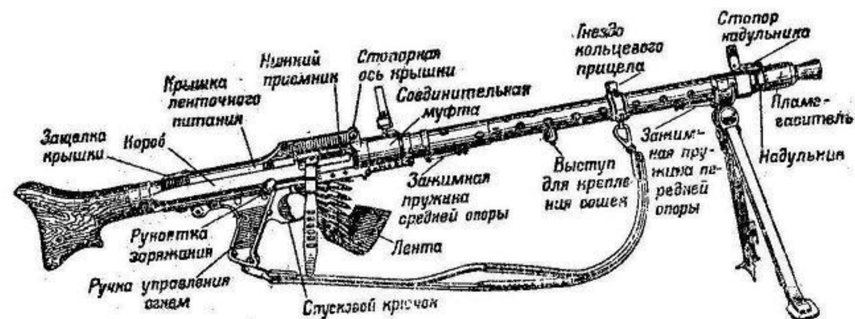
Рис. 170. Пулемет МГ-34 как ручной с ленточным питанием
