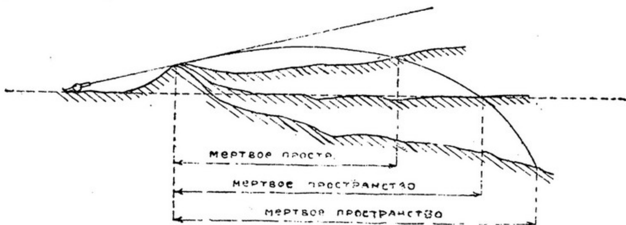
Черт. 14. Изменение величины мертвого пространства с понижением или повышением местности от гребня закрытия.
