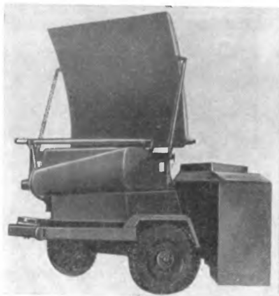
Рис. 43. Радиолокационная станция AN/MPQ-4
