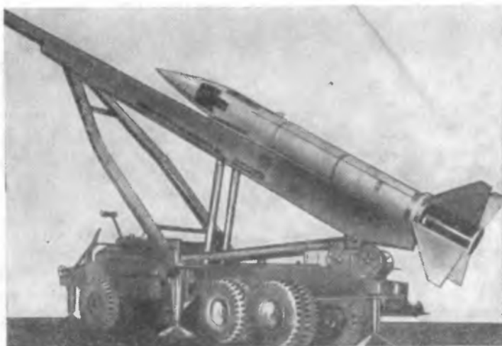
Рис. 64. Общий вид пусковой установки с неуправляемым реактивным снарядом «Онест Джон» в боевом положении
