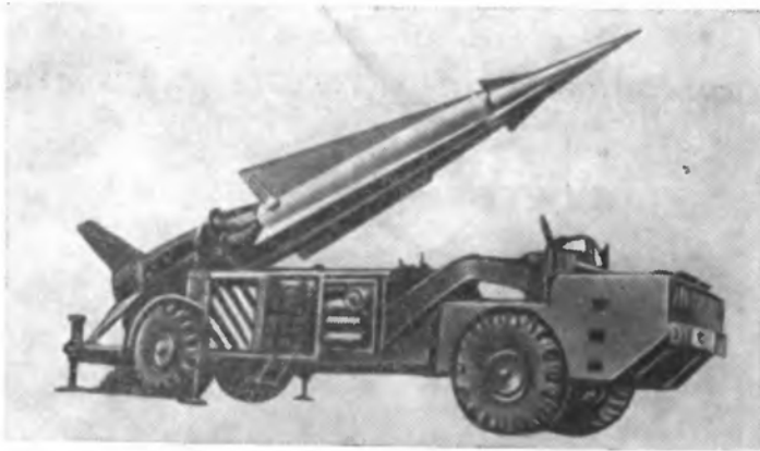
Рис. 77. Подвижная пусковая установка ЗУРС «Найк Геркулес»
