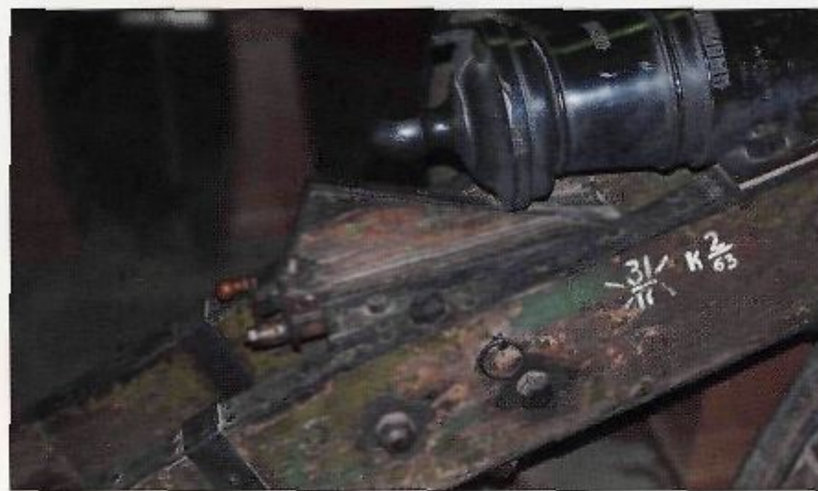
Казенная часть единорога с вингардом и креплением прицела
