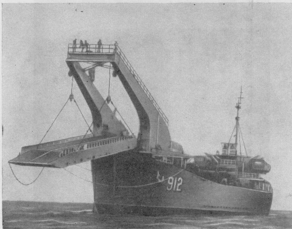
Рис. 25. Большой танко-десантный корабль ВМС США «Мэхон Каунти» LST-912 с носовым высадочным устройством нового типа
