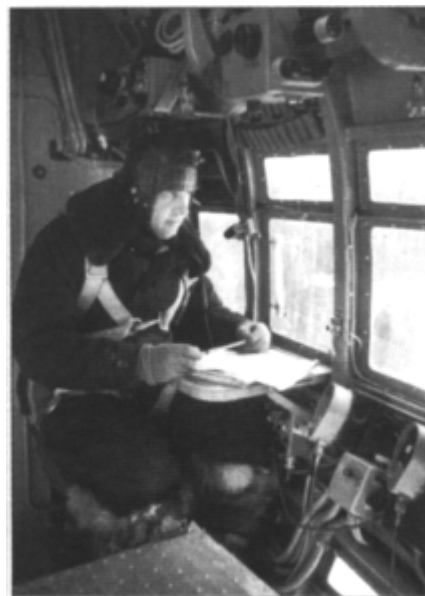
Штурман А.М. Лебедев работает за откидным столиком. Над его головой уложен в походные крепления прицел ОПБ-2, за боковым окном – наружный термометр.
