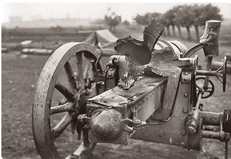
*Искореженное от взрыва артиллерийское орудие*
