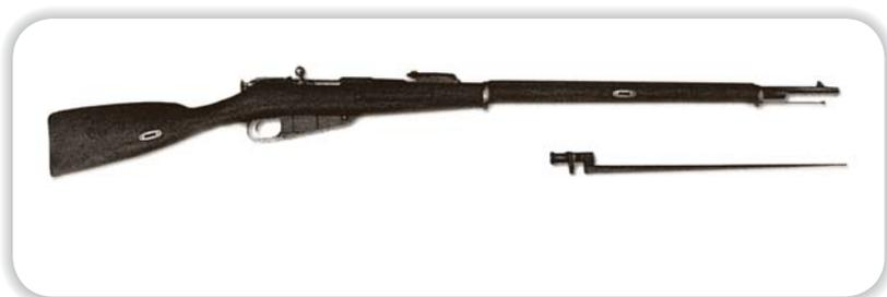
*Трехлинейная пехотная винтовка образца 1891 г. американского производства, рядом — четырехгранный игольчатый штык*
