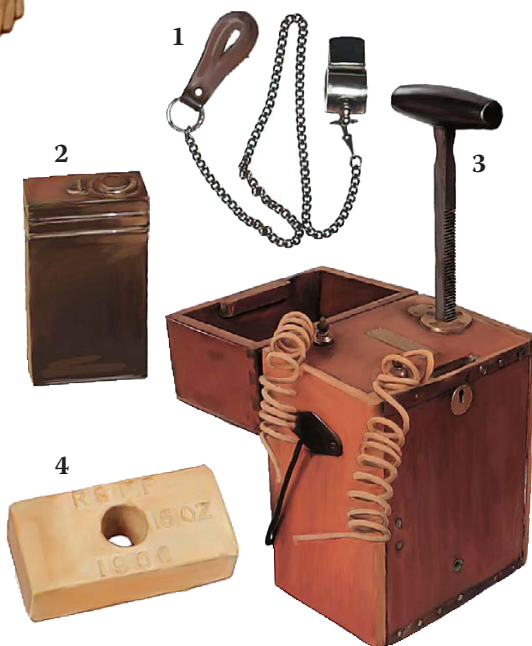
▼ Элементы снаряжения инженерных войск, 1917 г. 1. Офицерский свисток с кожаным ремешком и цепочкой. 2. Противогазная сумка. 3 и 4. Оборудование для закладки, снаряжения и подрыва мин.
