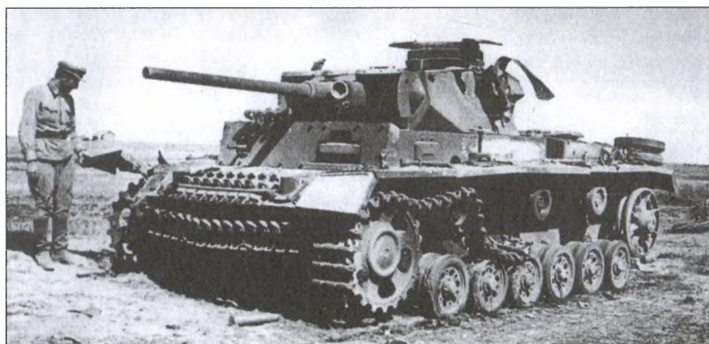
Средний танк Pz.Kpfw.III Ausf.J, подбитый нашими войсками. Запасные траки гусениц, подвешенные в передней части машины, одновременно служили для усиления лобовой брони. Группа армий «Юг», май 1942 года
