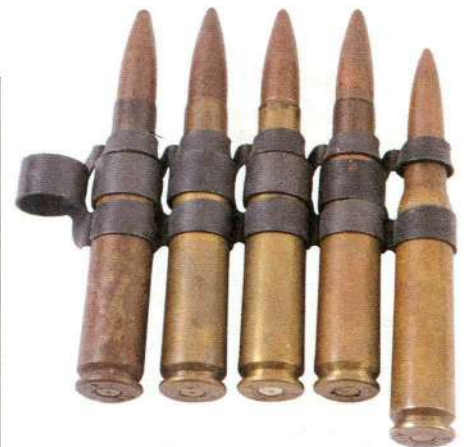
Вверху: Несколько патронов калибра .50 в секции металлической рассыпной звеньевой патронной ленте.
