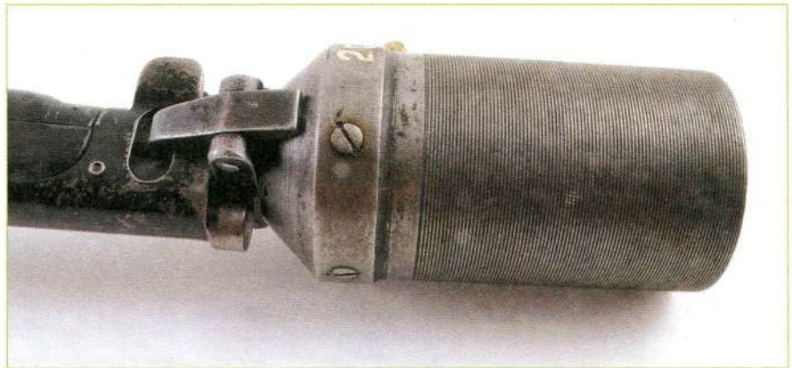
Вверху и справа: Еще одна SMLE для стрельбы гранатами, здесь с медными биндажами вокруг ствола. Вид крупным планом показывает пусковую чашку под стандартную гранату № 36.
