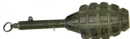
Внизу и справа: Винтовочные гранаты. В центре стандартная ручная граната Mk II, закрепленная на пусковой трубке, устанавливавшейся на надульное устройство, и выстреливавшаяся холостым зарядом.
