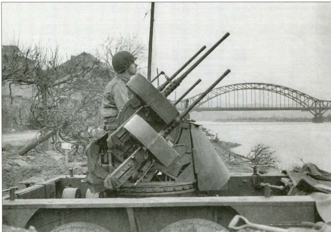
Вверху: Maxson Mount в кузове автомашины со счетверенными тяжелыми пулеметами М2 калибра .50. Установка иногда применялась для ведения наземного, сметающего всё огня.
