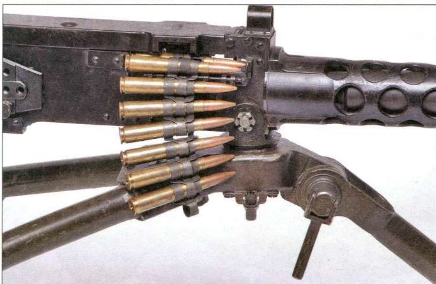
Внизу: Увеличенный вид пулеметной ленты и крепление треноги. Оружие и тренога весили около 57 кг.
