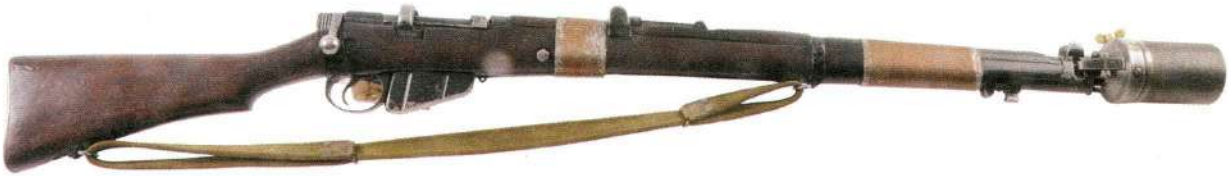
Вверху и справа: Еще одна SMLE для стрельбы гранатами, здесь с медными биндажами вокруг ствола. Вид крупным планом показывает пусковую чашку под стандартную гранату № 36.
