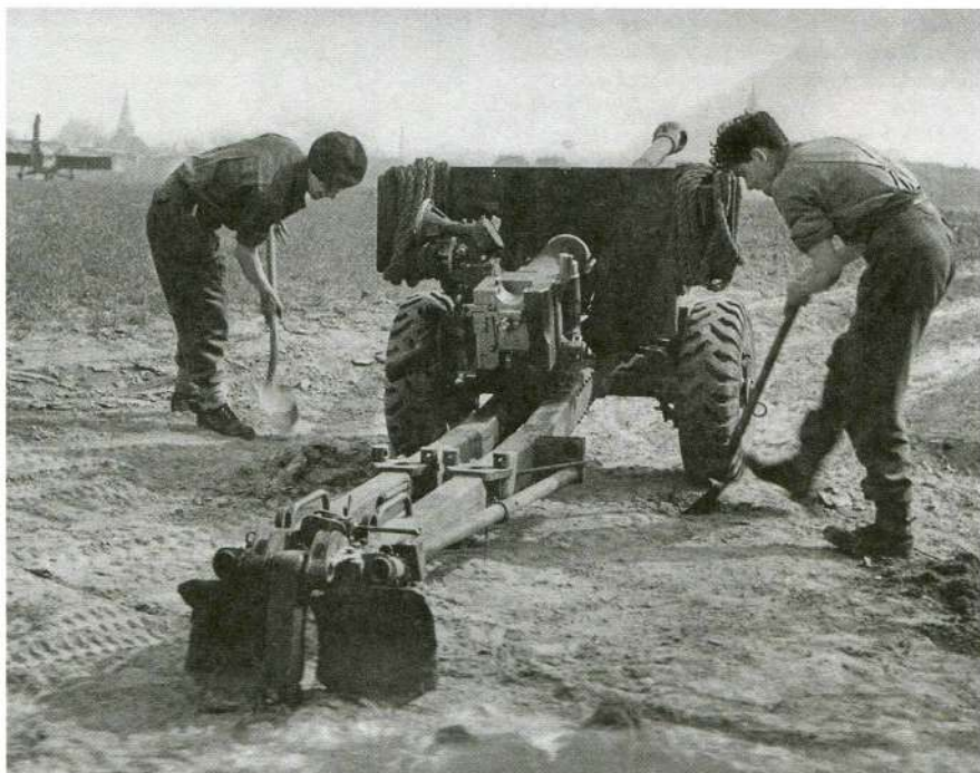
Установка «6-фунтовки» на позицию. Пушка исправно использовалась с 1943 г. и до конца войны благодаря низкому профилю и небольшому весу.
