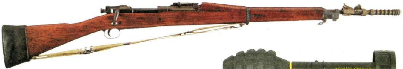
Вверху: Винтовка М1903 Springfield с надульным устройством для стрельбы винтовочными гранатами.
