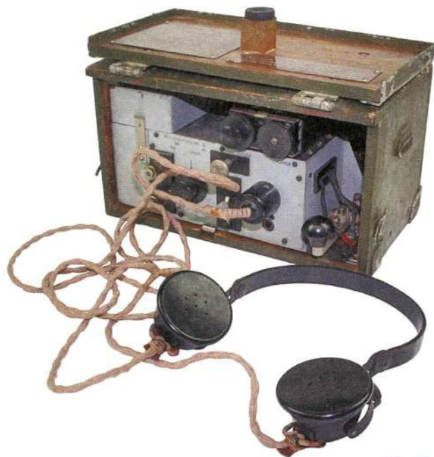
Вверху: Fullerphone позволял работать морзянкой по линиям голосовой связи и одновременно с речевыми сообщениями.
