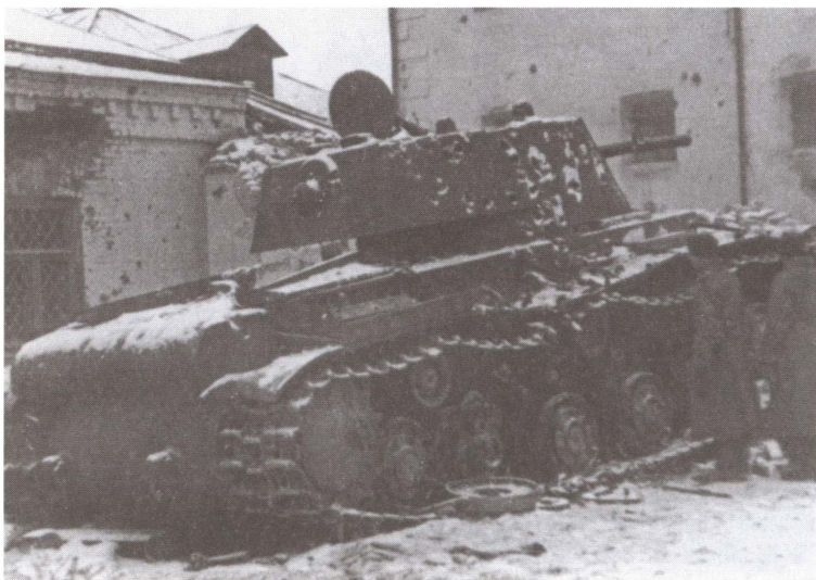
Подбитый 27 ноября 1941 г. у тюрьмы города Венев советский танк КВ-1 32-й танковой бригады. В правом борту танка — не менее 20 попаданий снарядов разного калибра, прострелен ствол орудия
