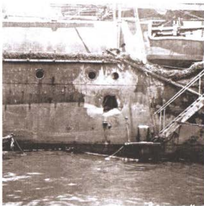
▲ Пробоина в борту крейсера I ранга «Олег», полученная в Цусимском сражении.
