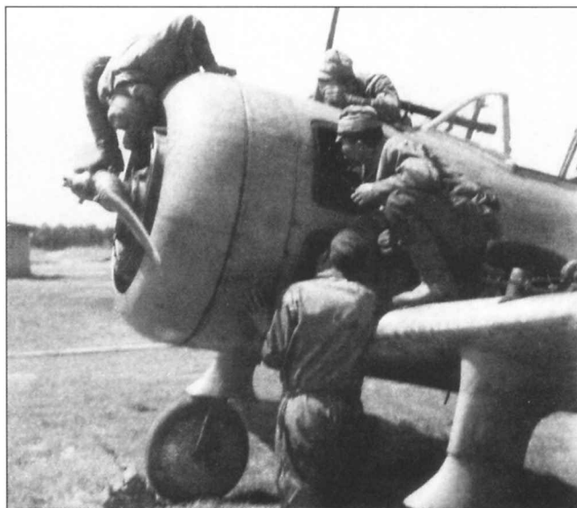
Техобслуживание Ки-27 Оцу из 11-го сентября. На нижнем снимке хорошо виден характерный для этой машины кольцевой маслорадиатор и стойка радиоантенны
