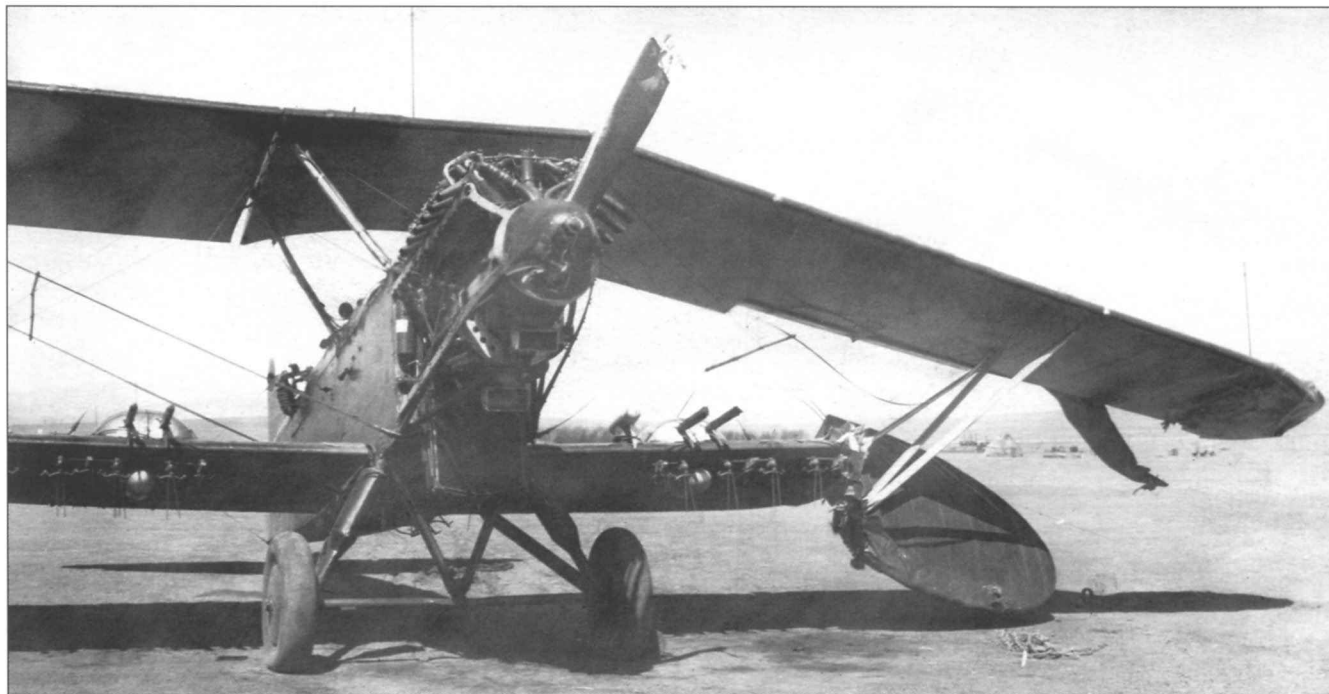
Здесь и внизу: ЛШ-5 (Р-5Ш) из штабного звена 70-го иап, потерпевший аварию в декабре 1938 г. на аэродроме «Баин-Тумен». Ранее самолет принадлежал 150-му сбп. Самолет окрашен в защитно-зеленый цвет, тактический номер «7» нанесен белым контуром, «пилотка» кия желтая или голубая
