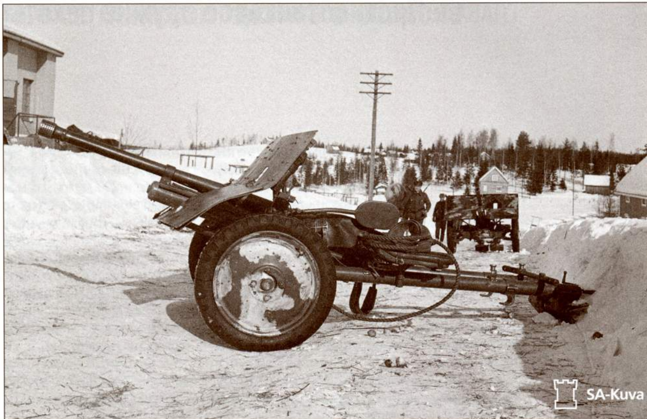
Финская противотанковая пушка «Бофорс» калибра 37 мм
