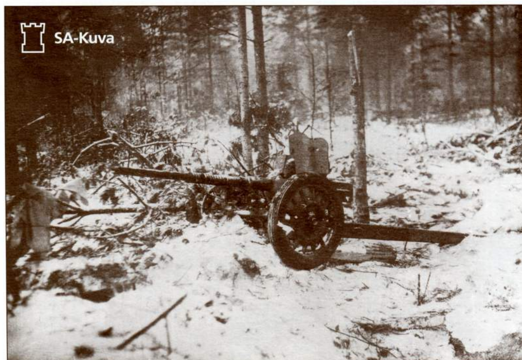
Финская противотанковая пушка «Бофорс» калибра 37 мм
