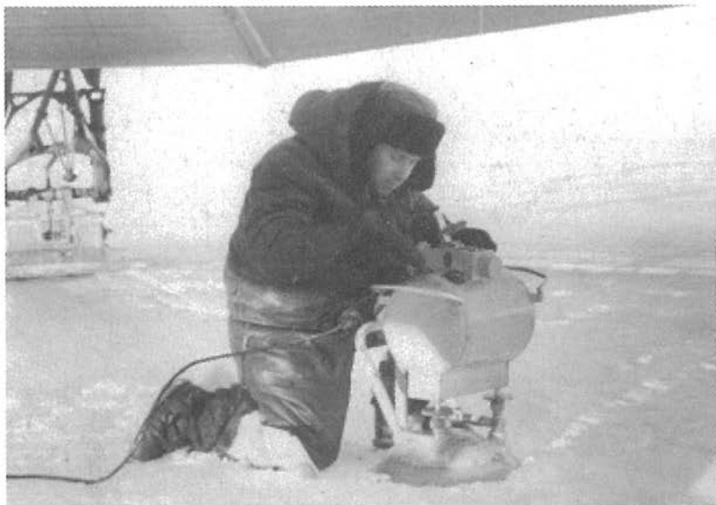
Антарктическая экспедиция. Военный геодезист производит гравиметрические измерения гравиметром СН-3 в самолетных рейсах. 1961 г.
