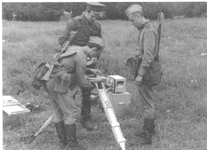
61-й топогеодезической отряд. Установка гиротеодолита. 1980 г.
