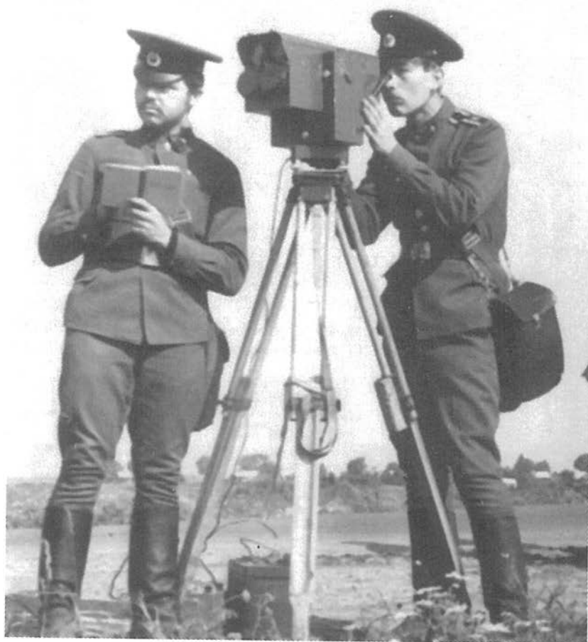
Курсанты ЛВВТКУ выполняют геодезические работы с использованием дальномера КТД-1. 1980-е гг.
