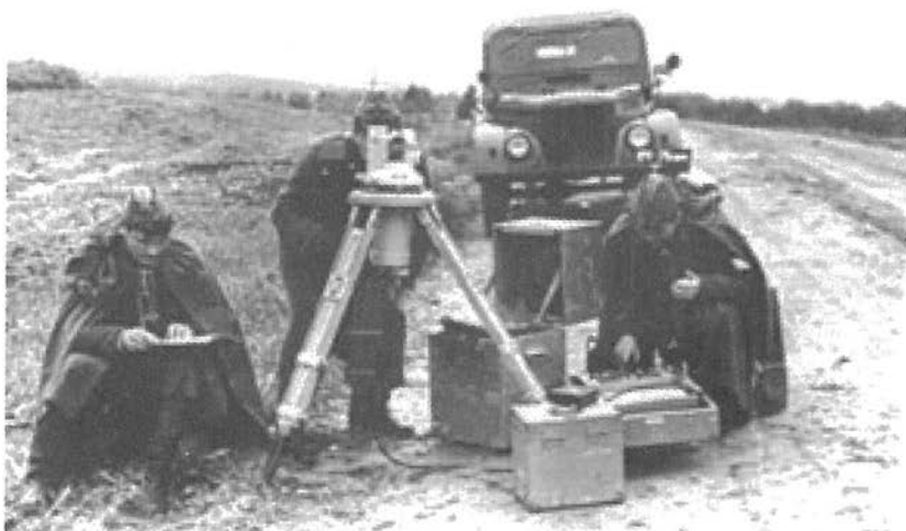
Определение азимута гироскопическим методом. 1974 г.
