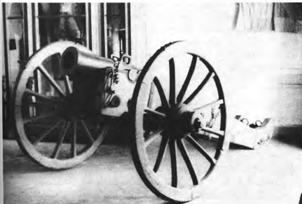
Французская 6-дюймовая гаубица, две такие пушки были обычно приданы каждой артиллерийской батарее Великой армии
