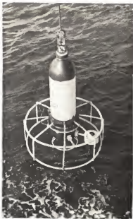
Прибор для измерения тонкой вертикальной структуры, температуры и электропроводности воды
