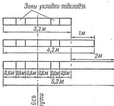
Рис. 423. Типы мостовых брусьев по длинам
