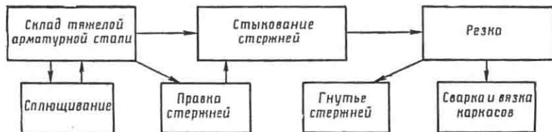
Участок для тяжелой арматуры
