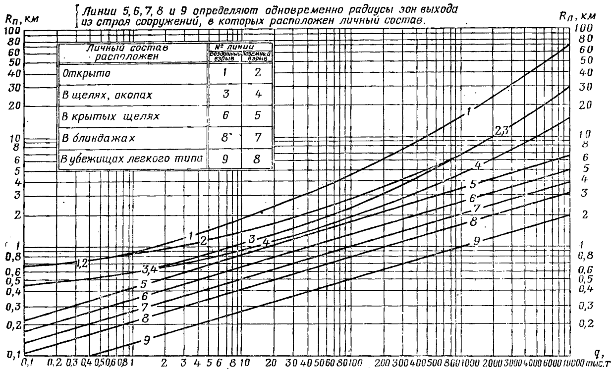
Рис. 9.1. График для определения радиусов зон выхода из строя личного состава при воздушных и наземных ядерных взрывах
