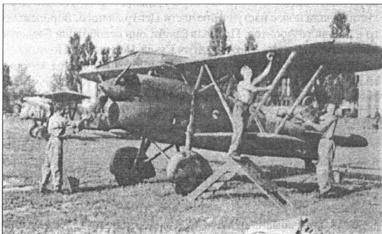
Истребитель Vf-109G-2 V.758 из первой серии самолетов Vf-109G, собранных на авиазаводе в г. Дьёре
