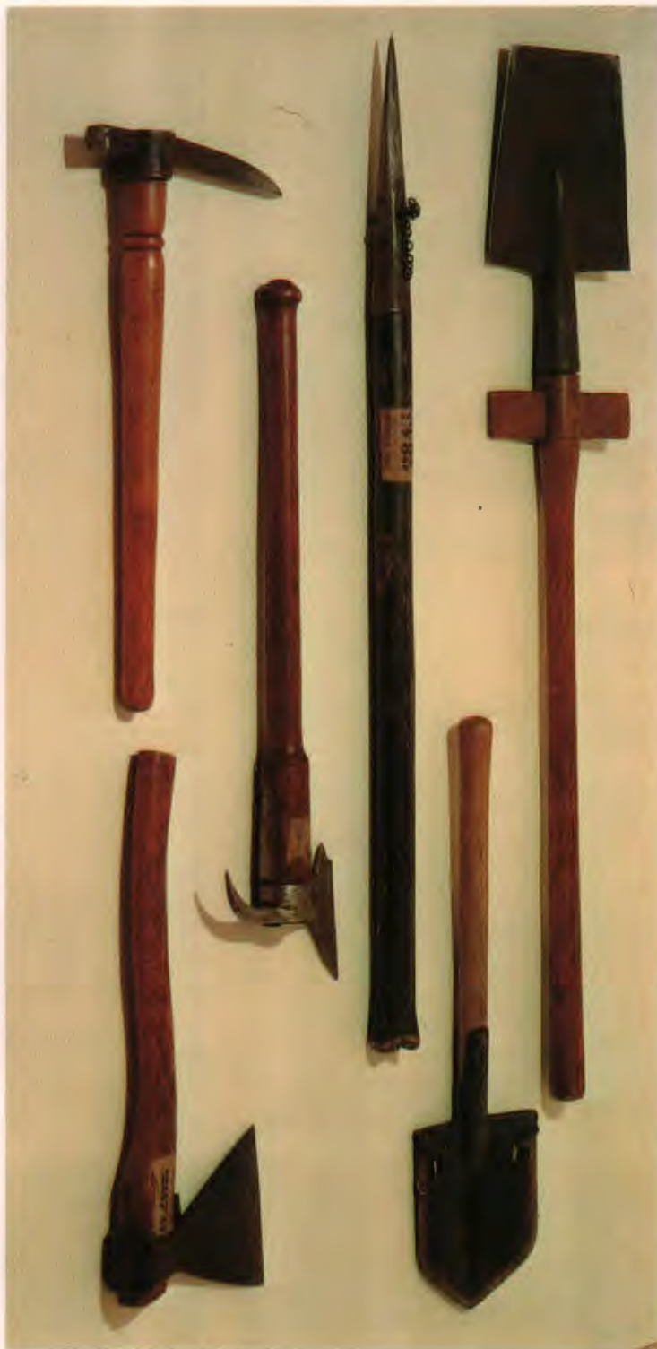
Шанцевый инструмент русской армии: лопата, лопата саперная, лом саперный, топор с багром, топор шанцевый, кирка саперная
