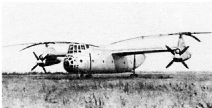
Первый отечественный винтокрыл Ка-22 – самолет и вертолет в одном аппарате – готов к первому полету. 1960 год.
