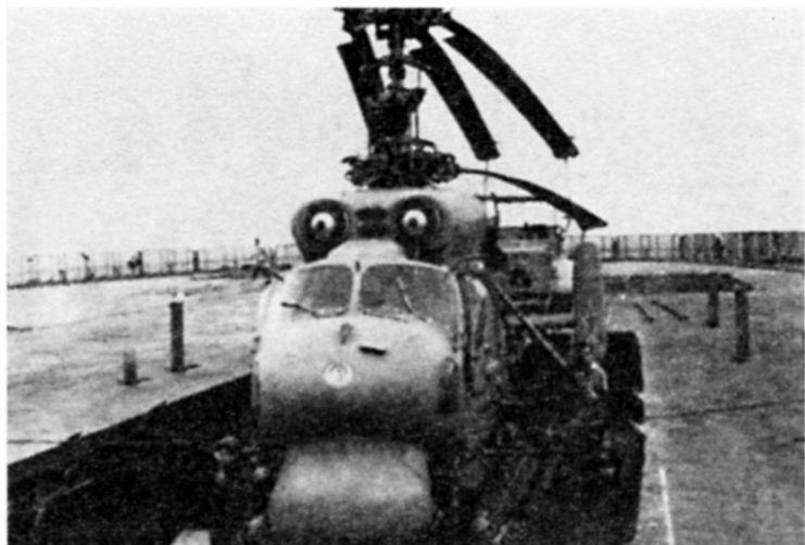
Вертолет Ка на подъемнике во время швартовочных испытаний на крейсере «Москва».
