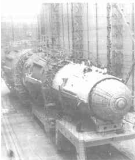
Ракета-носитель Н1 на монтажной тележке в монтажно-испытательном корпусе космодрома
